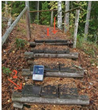
Trepp on sensormattide paigaldamiseks hea koht. Number üks näitab kohta, kuhu on maetud sensormatt, ja number 2 näitab, kuhu on tavaliselt peidetud loendur (trepiastme alla). RMK Põhja-Eesti puhkeala. (FOTO: JAAK NELJANDIK)
