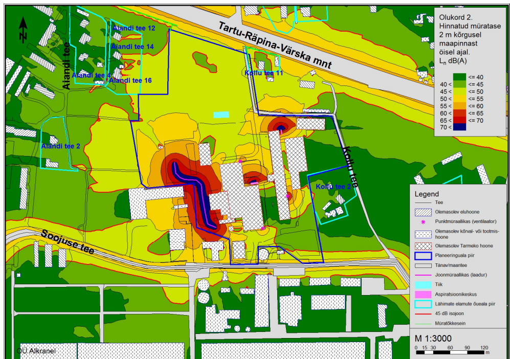
Joonis 4.4. Olemasoleva olukorraga (sh Tartu – Räpina – Värsk maanteeliiklus) kaasnev müratase öisel ajal.
