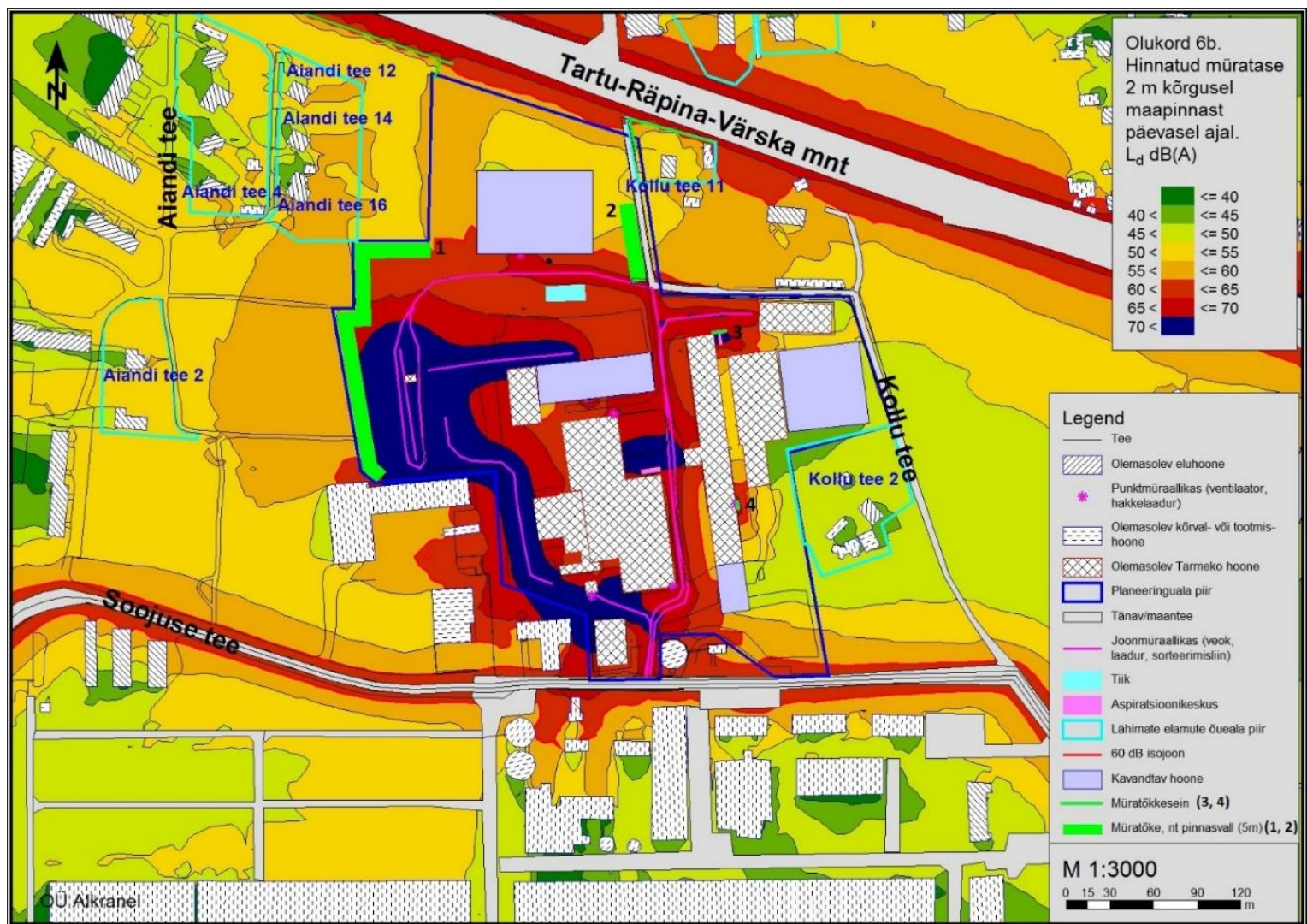
Joonis 4.3.4. Alternatiiv I - kaasnev müratase päevasel ajal, kui rakendatud on leevendavaid meetmeid (4 tk, joonisel tumedad nr 1-4), Alkranel OÜ (2017; vt ka KSH lisa 7). Kavandatud hooned, visioon, ei piira üldist hoonete arvu, mille puhul lähtuda DP-s sätestatust (arvestades ka Ehitusseadustiku ehitiste def).
