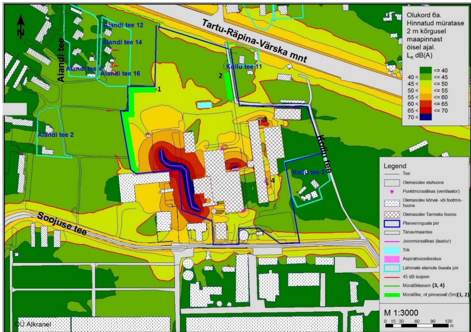
Joonis 4.3.3. 0-alternatiiv - kaasnev müratase öisel ajal, kui rakendatud on leevendavaid meetmeid (4 tk, joonisel tumedad nr 1-4), Alkranel OÜ (2017; vt ka KSH lisa 7).
