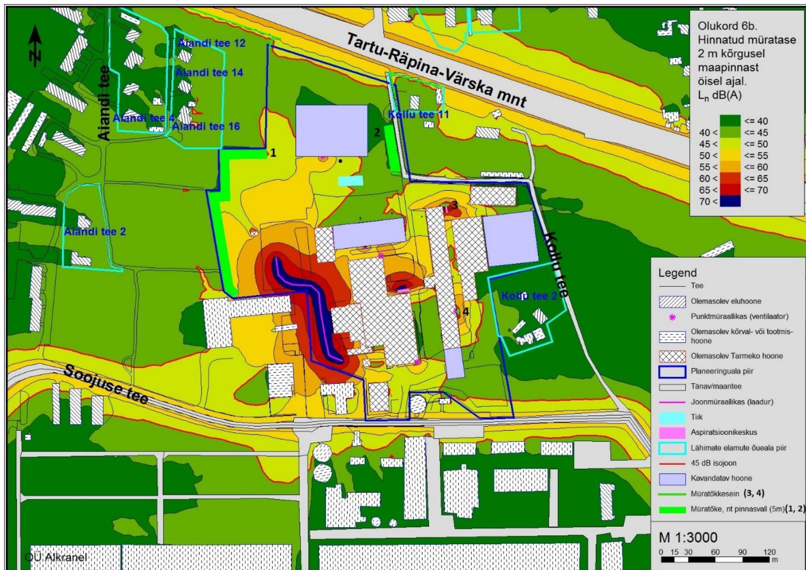
Joonis 4.3.5. Alternatiiv I - kaasnev müratase öisel ajal, kui rakendatud on leevendavaid meetmeid (4 tk, joonisel tumedad nr 1-4), Alkranel OÜ (2017; vt ka KSH lisa 7). Kavandatud hooned, visioon, ei piira üldist hoonete arvu, mille puhul lähtuda DP-s sätestatust (arvestades ka Ehitusseadustiku ehitiste def).
