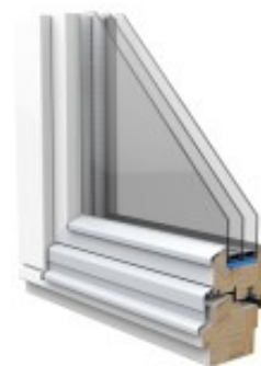
Alumised lengi- ja raamipuude välisservad on kaetud alumiiniumprofiilidega
