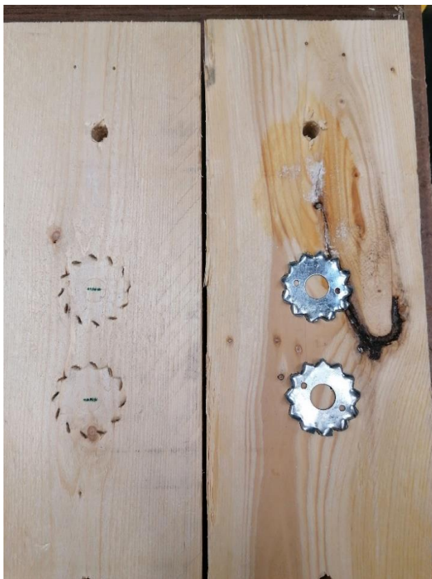
L6.7. Katsekeha LT7-C1 hammastüübli hammaste jäljend.
