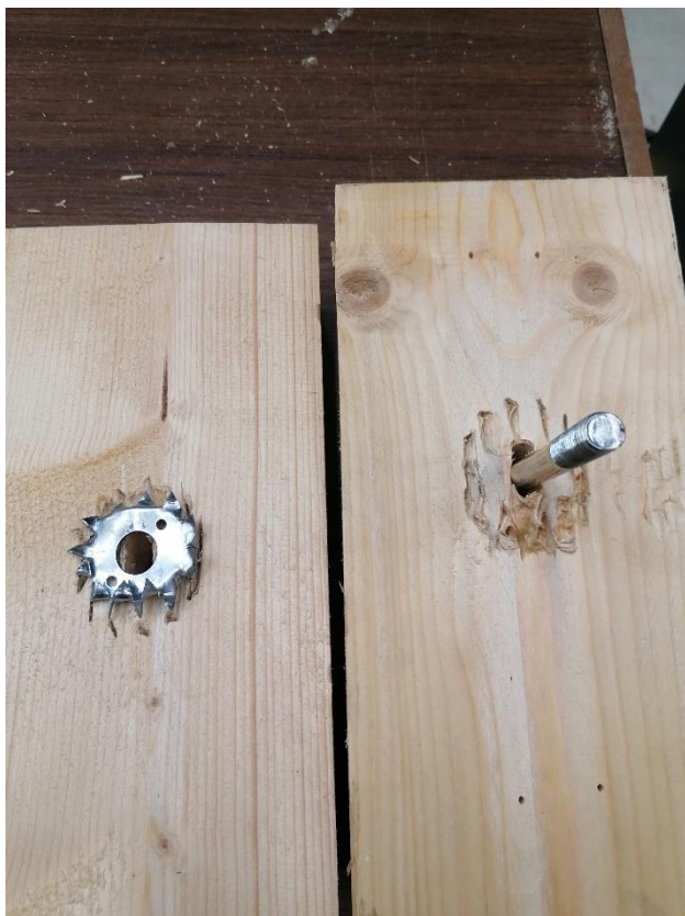
L3.5. Katsekeha NK5-1xC1 puidu ja hammastüübli muljumine.
