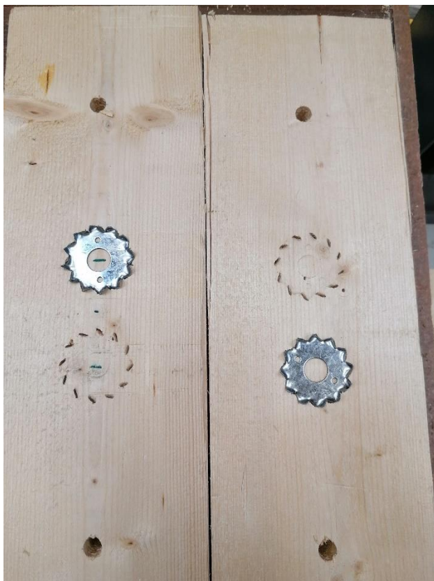
L6.1. Katsekeha LT1-C1 hammastüübli hammaste jäljend.
