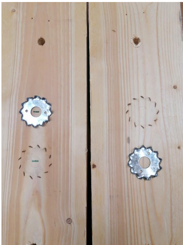
L6.9. Katsekeha LT9-C1 hammastüübli hammaste jäljend.
