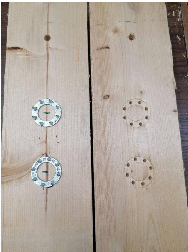
L7.10. Katsekeha LT10-C10 hammastüübli muljumisjälgend.
