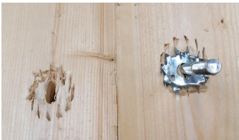
Joonis 3.16. C1 tüüpi hammastüübli tüüpiline purunemispilt ja muljumisjäljend nihkekatset.
