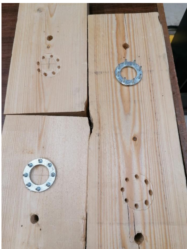
L5.6. Katsekeha JT6-C10 hammastüübli ja puidu muljumine.
