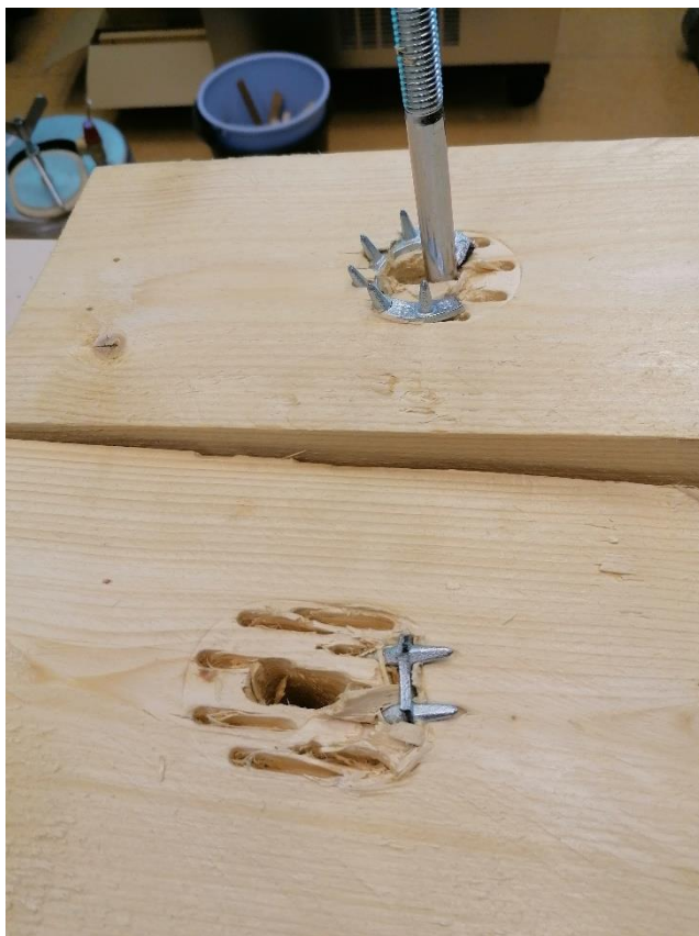
L2.7. Katsekeha NK7-1xC10 hammastüübli purunemine ja muljumisjälg.
