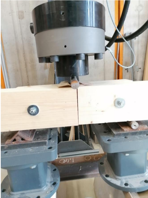
Joonis 2.13. Jätkatud tala katsekeha asetus enne kolme punkti paindekatse algust.
