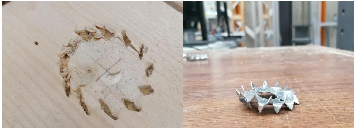
Joonis 3.18. Jätkatud tala paindekatses tüüpiline C1 hammastüübli deformatsioon ning muljumisjalg puidus.
