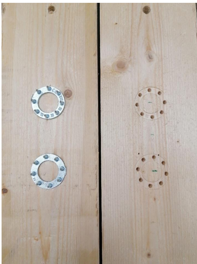
L7.1. Katsekeha LT1-C10 hammastüübli muljumisjälgend.
