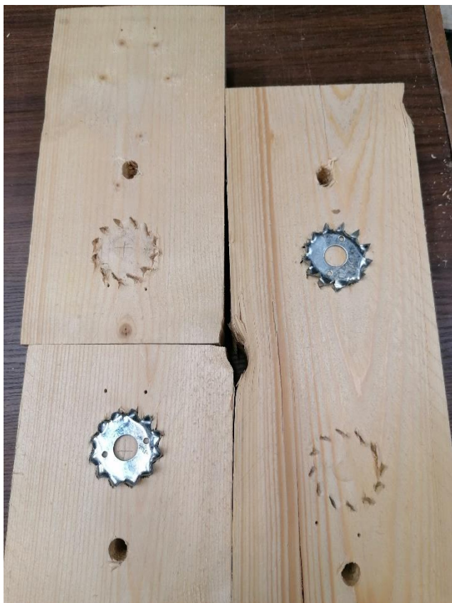
L4.3. Katsekeha JT3-C1 hammastüübli ja puidu muljumine.
