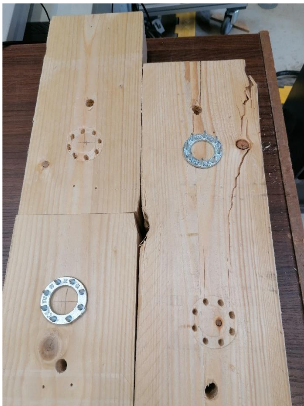
L5.9. Katsekeha JT9-C10 hammastüübli ja puidu muljumine.
