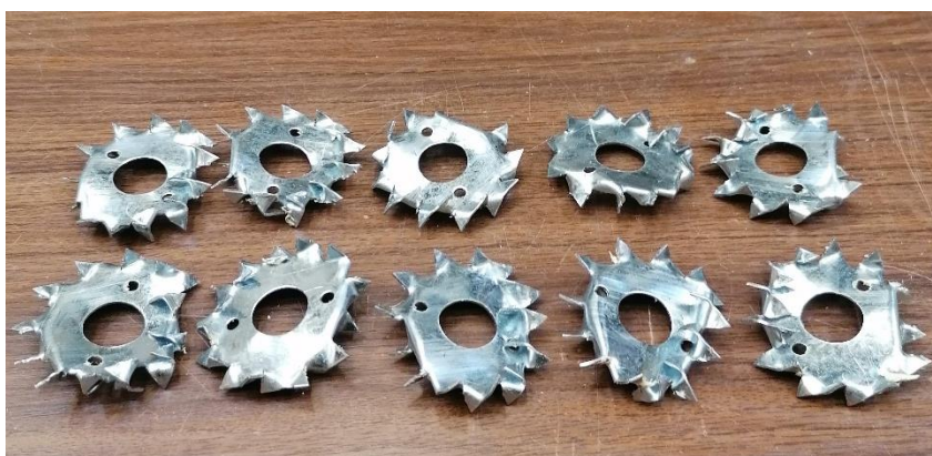
Joonis 3.17. C1 hammastüüblite deformeerumised nihkekatse järel.
