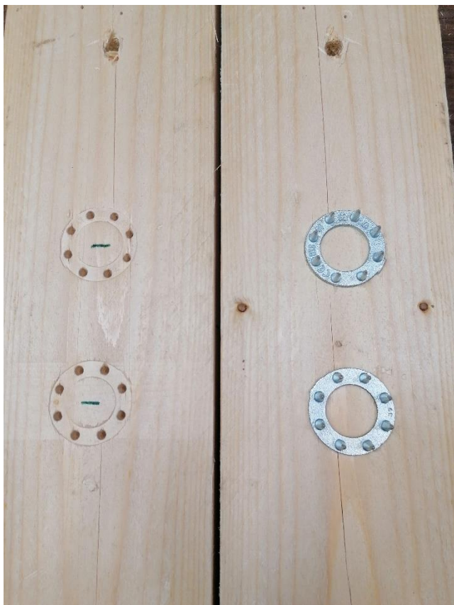
L7.5. Katsekeha LT5-C10 hammastüübli muljumisjäljend.
