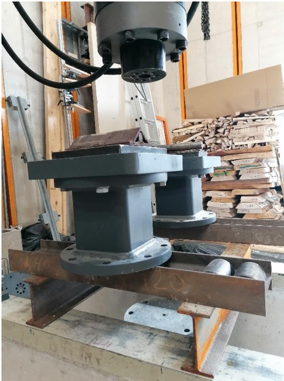
Joonis 2.12. Liittala ja jätkatud tala toetusraamistik.
