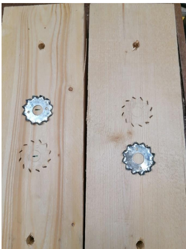
L6.2. Katsekeha LT2-C1 hammastüübli hammaste jäljend.
