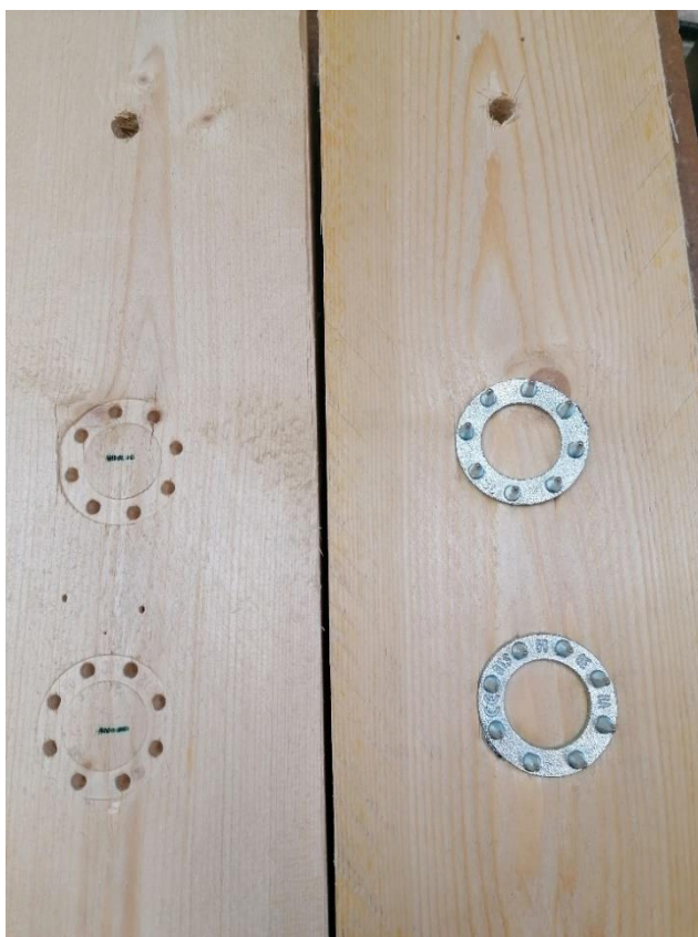
L7.6. Katsekeha LT6-C10 hammastüübli muljumisjäljend.
