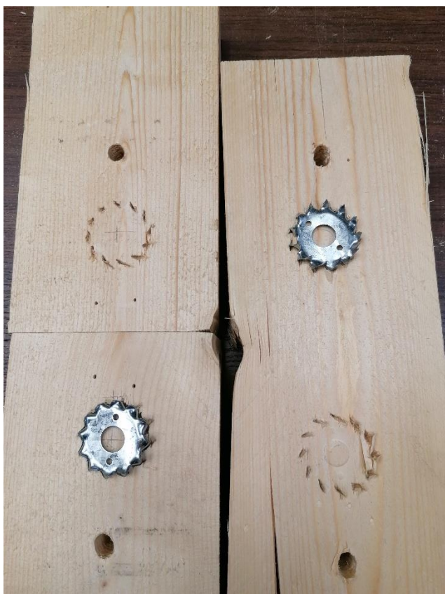
L4.4. Katsekeha JT4-C1 hammastüübli ja puidu muljumine.
