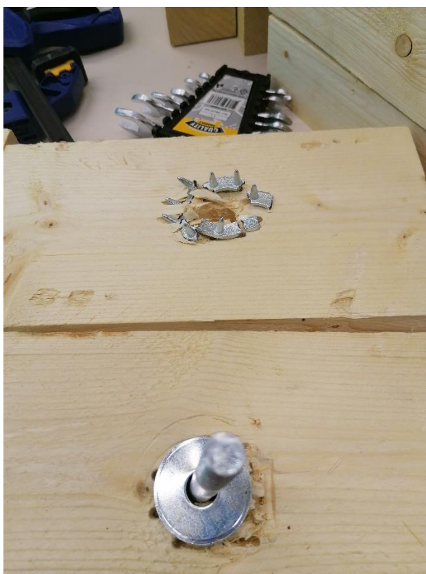
L2.10. Katsekeha NK10-1xC10 hammastüübli purunemine ja jäljend.
