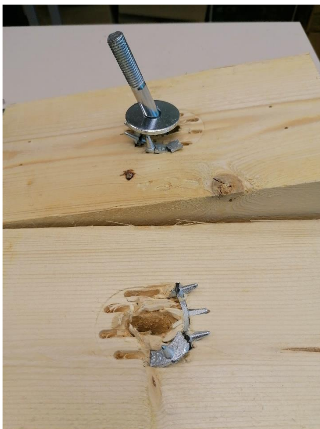
L2.8. Katsekeha NK8-1xC10 hammastüübli purunemine ja muljumisjälg.
