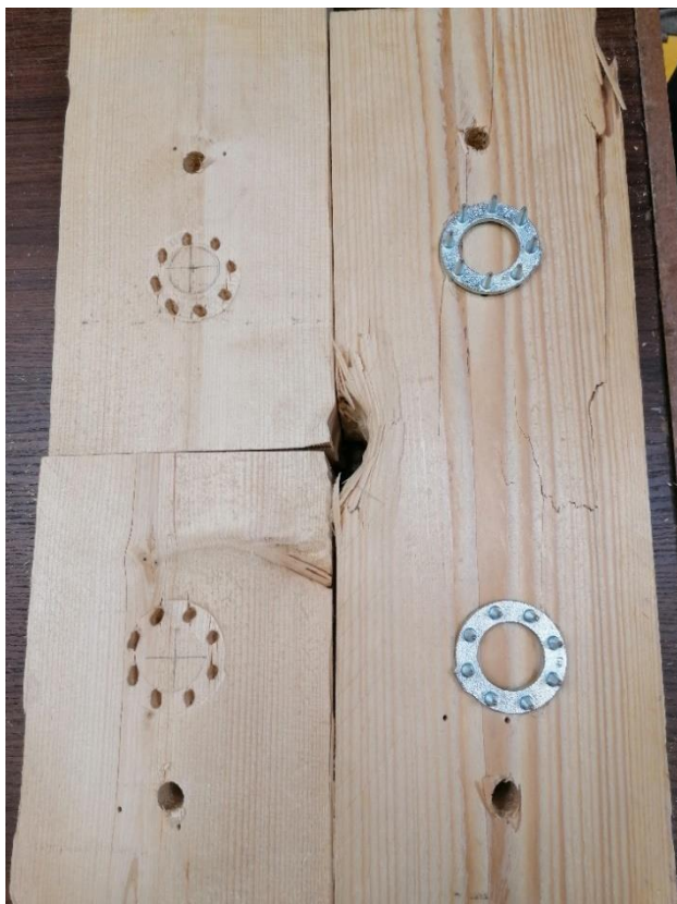
L5.5. Katsekeha JT5-C10 hammastüübli ja puidu muljumine.
