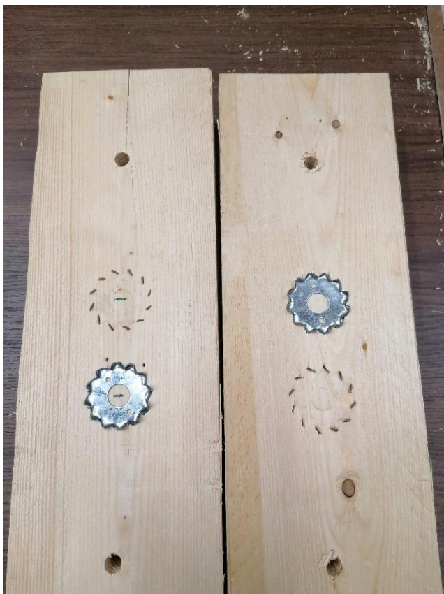
L6.3. Katsekeha LT3-C1 hammastüübli hammaste jäljend.
