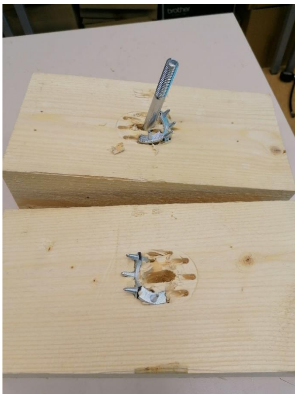
L2.4. Katsekehale NK4-1xC10 tekkinud muljumisjäljend ja tüübli purunemine.
