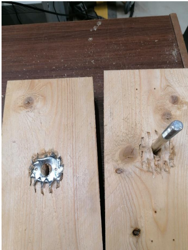
L3.10. Katsekeha NK10-1xC1 hammastüübli ja puidu muljumine.
