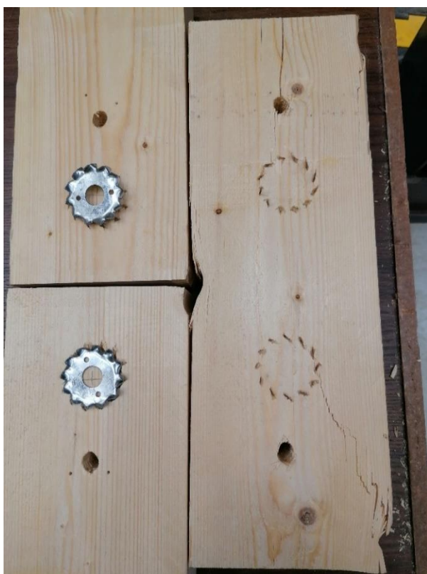
L4.2. Katsekeha JT2-C1 hammastüübli ja puidu muljumine.
