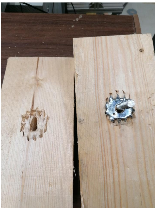
L3.4. Katsekeha NK4-1xC1 hammastüübli ja puidu muljumine.
