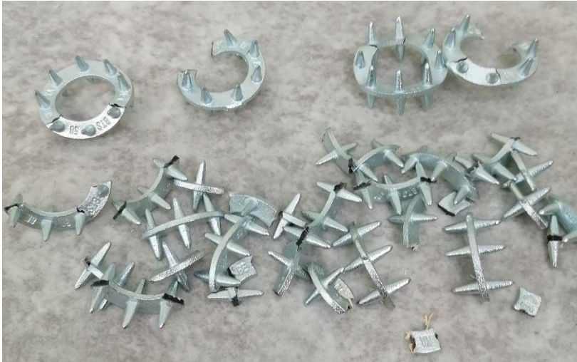
Joonis 3.14. Nihkekatsetel täielikult purunenud C10 hammastüüblid.
