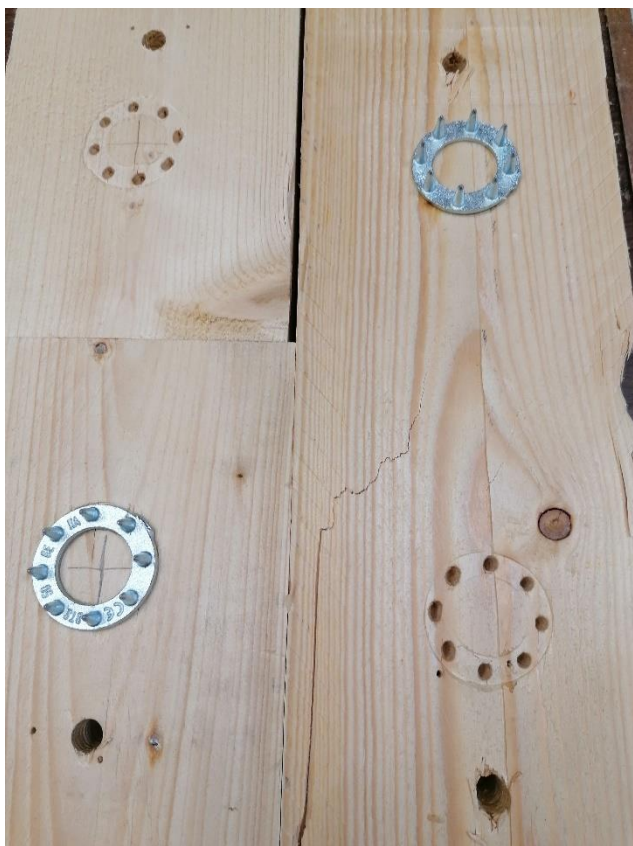
L5.8. Katsekeha JT8-C10 hammastüübli ja puidu muljumine.
