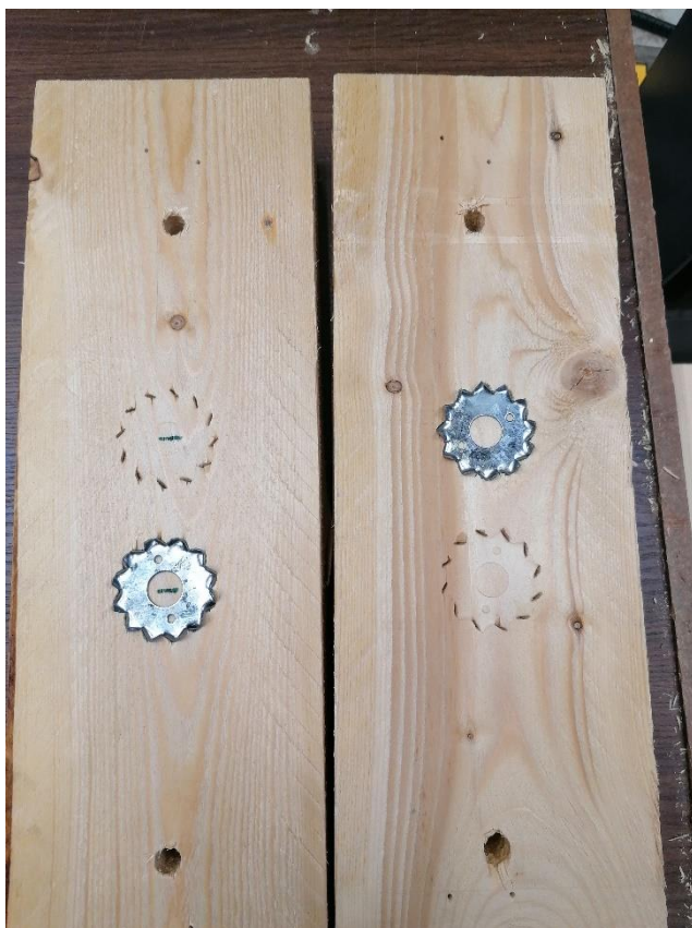
L6.8. Katsekeha LT8-C1 hammastüübli hammaste jäljend.
