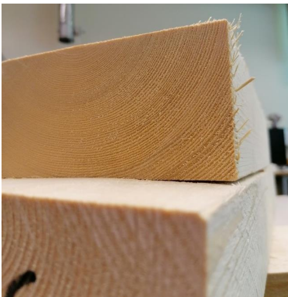
Joonis 2.9. Kõveraks kuivanud katsekehade tavapärane kokkusurutud olek.
