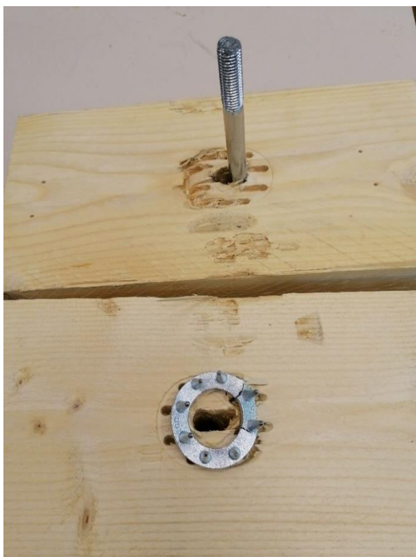
L2.2. katsekehale NK2-1xC10 tekkinud hammastüübli jäljend ja tüübli purunemine.
