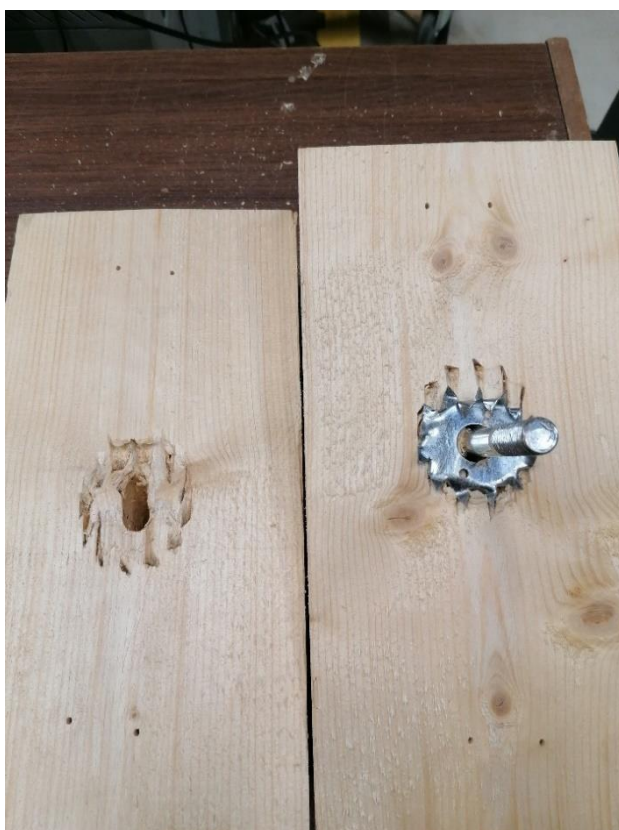
L3.8. Katsekeha NK8-1xC1 hammastüübli ja puidu muljumine.
