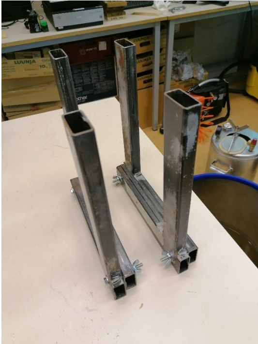
Joonis 2.6. Nihkekatsetel kasutatud toestusraam.
