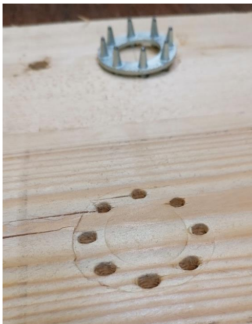
Joonis 3.19. C10 hammastüübli tüüpiline jälj peale paindekatses.
