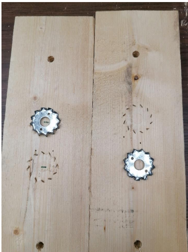
L6.5. Katsekeha LT5-C1 hammastüübli hammaste jäljend.
