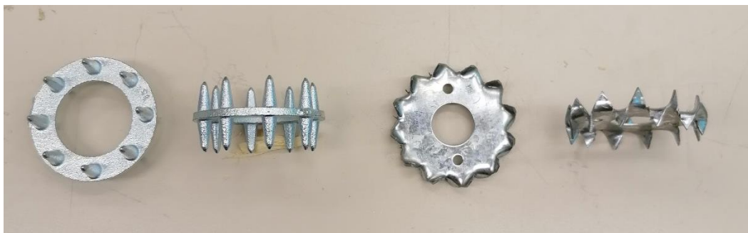
Joonis 2.5. Katsetel kasutatud hammastööblid. Vasakul C10 tüüpi hammastööbel d_c=50 mm ja paremal C1 tüüpi hammastööbel d_c=50 mm, kus d_c on hammastööbli läbimõõt.
