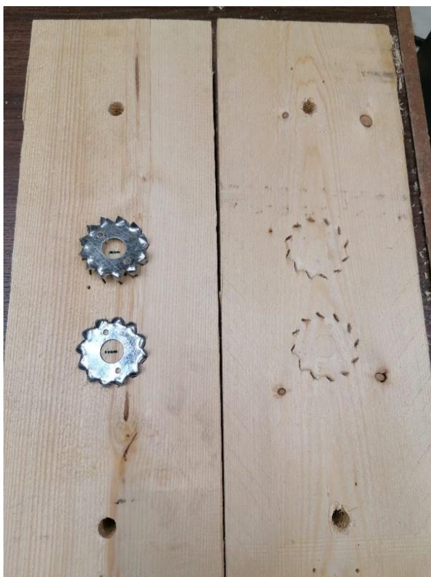
L6.4. Katsekeha LT4-C1 hammastüübli hammaste jäljend.
