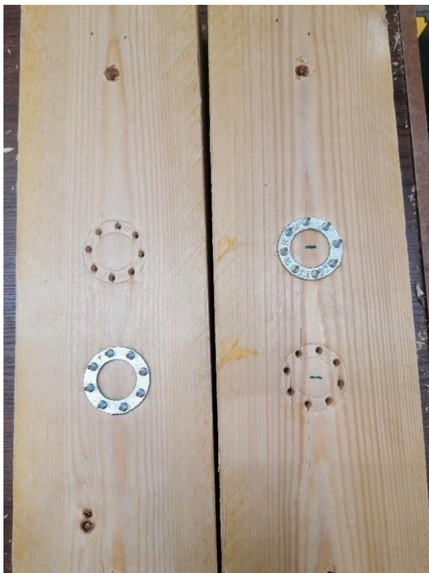
L7.8. Katsekeha LT8-C10 hammastüübli muljumisjäljend.
