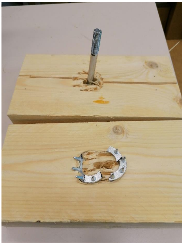
L2.3. Katsekehale NK3-1xC10 tekkinud muljumisjäljend, tüübli purunemine ja puidu lõhenemine.
