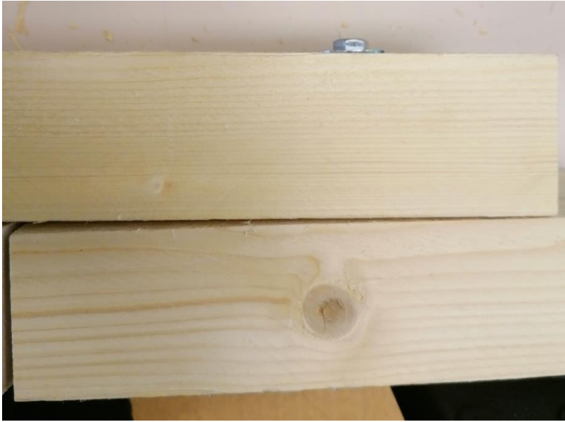
Joonis 2.8. Poldi pingutamise tõttu tekkinud kehade eemaldumine jätkatud tala keskkohast.
