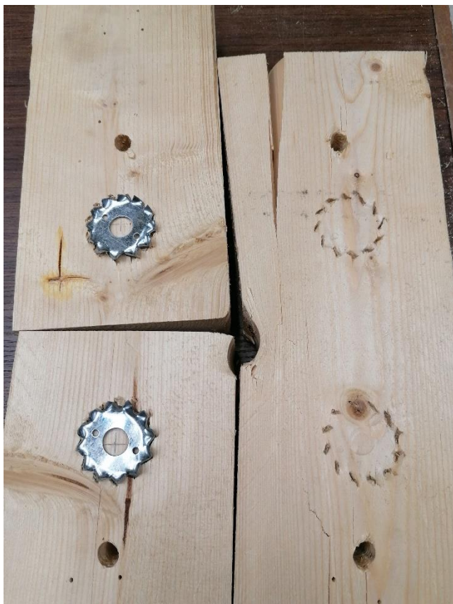
L4.5. Katsekeha JT5-C1 hammastüübli ja puidu muljumine.
