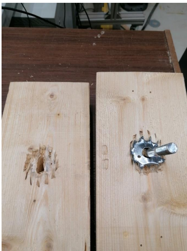
L3.2. Katsekeha NK2-1xC1 hammastüübli ja puidu muljumine.
