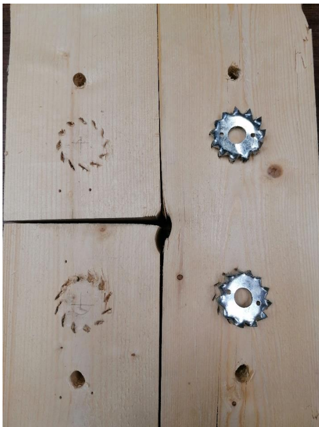
L4.1. Katsekeha JT1-C1 hammastüübli ja puidu muljumine.
