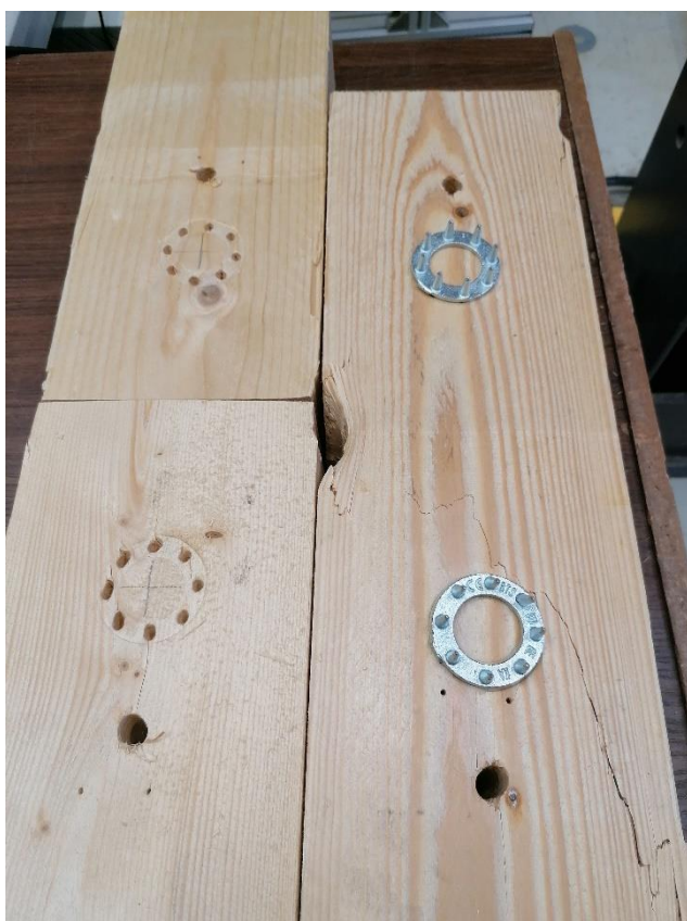
L5.10. Katsekeha JT10-C10 hammastüübli ja puidu muljumine.
