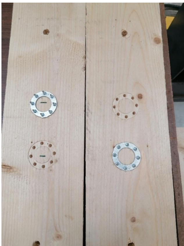
L7.4. Katsekeha LT4-C10 hammastüübli muljumisjäljend.
