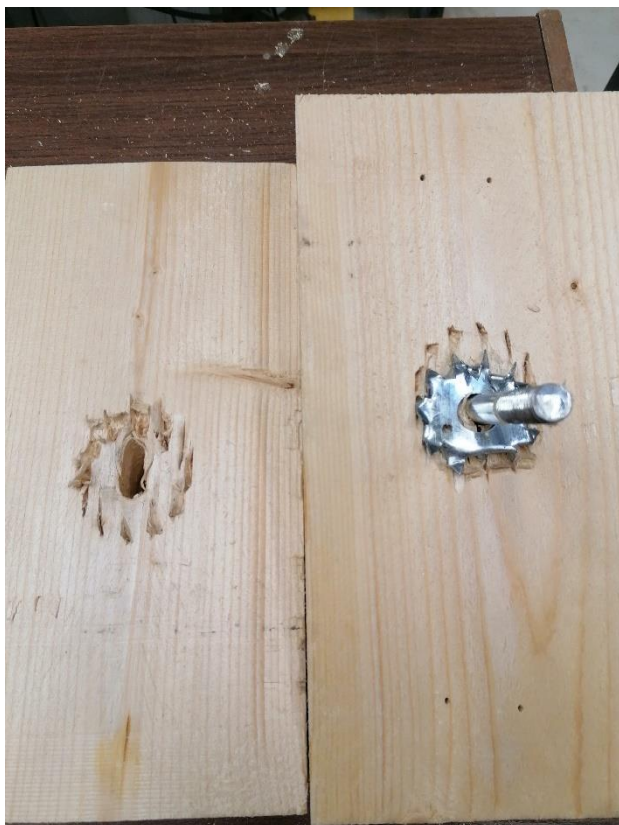
L3.7. Katsekeha NK7-1xC1 hammastüübli ja puidu muljumine.
