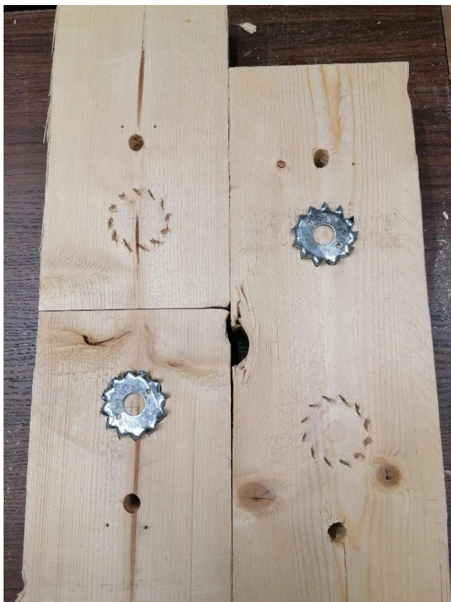
L4.9. Katsekeha JT9-C1 hammastüübli ja puidu muljumine.
