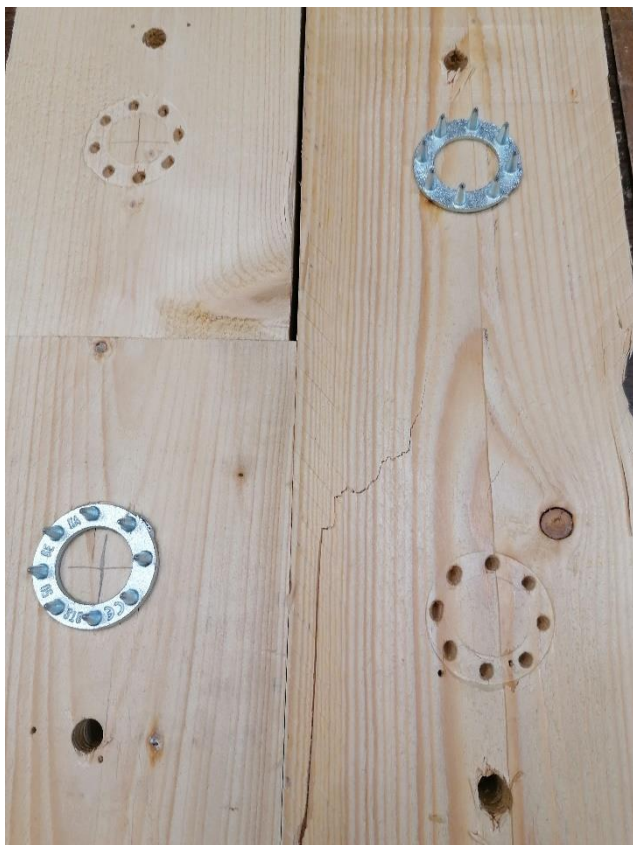
L5.7. Katsekeha JT7-C10 hammastüübli ja puidu muljumine.
