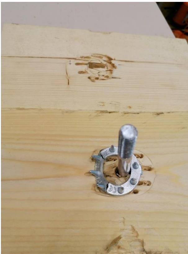
L2.6. Katsekeha NK6-1xC10 hammastüübli purunemine ja muljumisjäljend.
