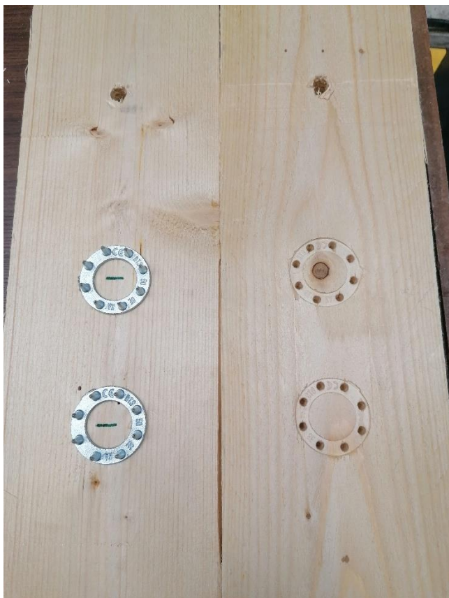
L7.7. Katsekeha LT7-C10 hammastüübli muljumisjäljend.
