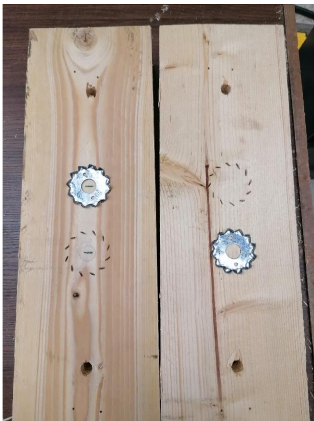
L6.6. Katsekeha LT6-C1 hammastüübli hammaste jäljend.
