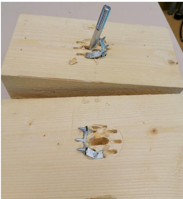
Joonis 3.15. C10/50 hammastüübli tüüpiline purunemispilt ja muljumisjäljend nihkekatsetel.
