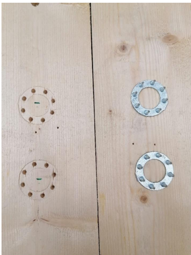
L7.2. Katsekeha LT2-C10 hammastüübli muljumisjälgend.
