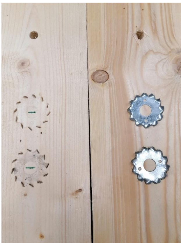
L6.10. Katsekeha LT10-C1 hammastüübli hammaste jäljend.
