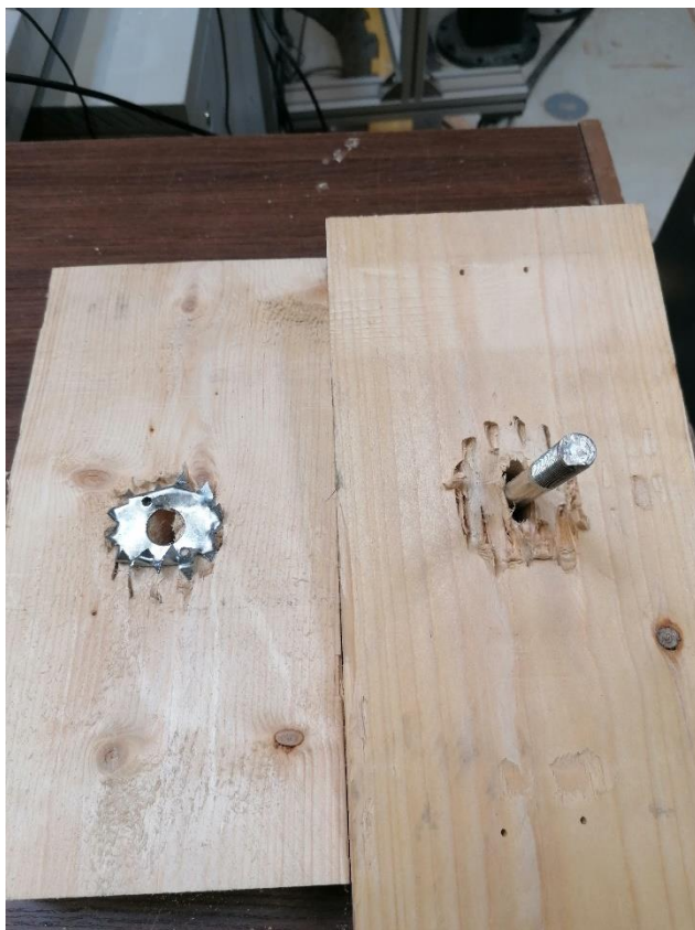
L3.3. Katsekeha NK3-1xC1 hammastüübli ja puidu muljumine.
