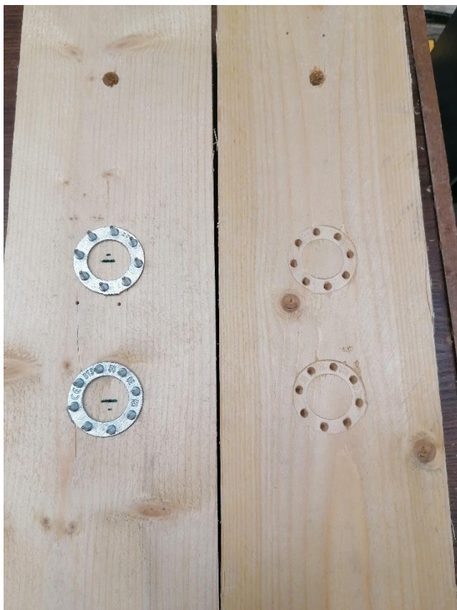
L7.3. Katsekeha LT3-C10 hammastüübli muljumisjäljend.
