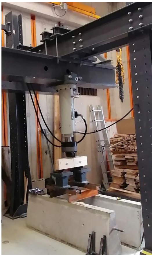
Joonis 2.11. Katsemasin Form+Test koos katsesilindriga EPZ-D 400.
