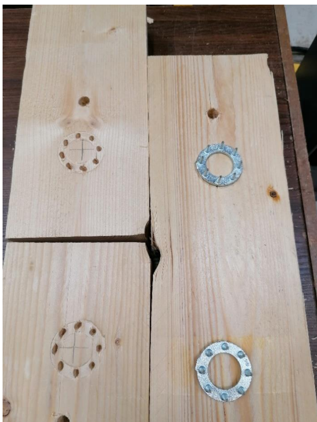
L5.2. Katsekeha JT2-C10 hammastüübli ja puidu muljumine.
