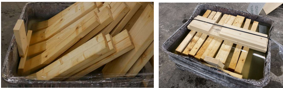
Joonis 2.24 Puitkarkassi märjutamine. Vasakul imiteeritakse seina alumise osa märgumist, paremal üleni veevanni paigaldatud karkassipostid
