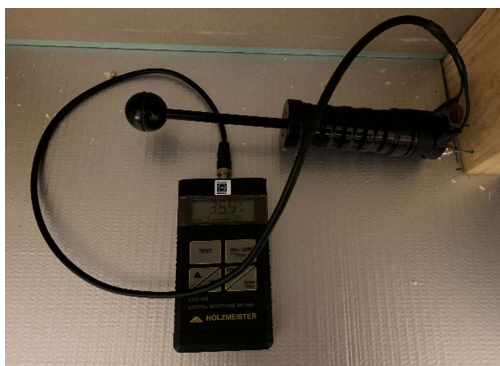
Joonis 2.13 Vasakul Gann Hydromette CH17, paremal Logica Holzmeister LG9 NG puidu niiskussisalduse mõõtmise seade, vasakul pildil on kujutatud ka elektroodide paigaldamiseks kasutatud ramm-vasar
