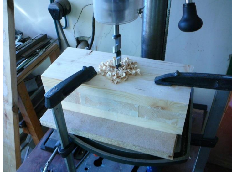
Joonis 2.10. Katsekehasse augu puurimine
