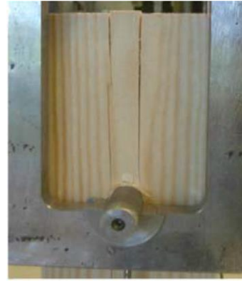
Joonis 1.23. Kareda naagli tüüpiline purunemispilt, kus vasakpoolsel joonisel on katsekeha vahetult enne purunemist ja parempoolsel katsekeha vahetult pärast purunemist [31]
