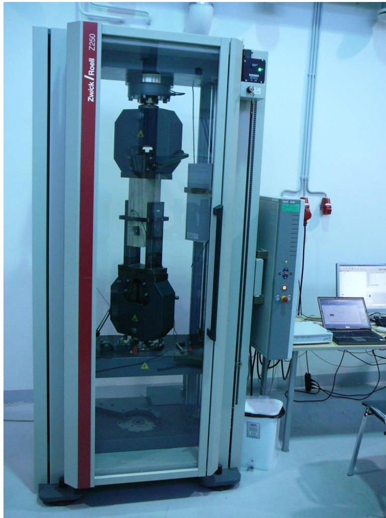
Joonis 2.11. Katseseade Zwick / Roell Z250
