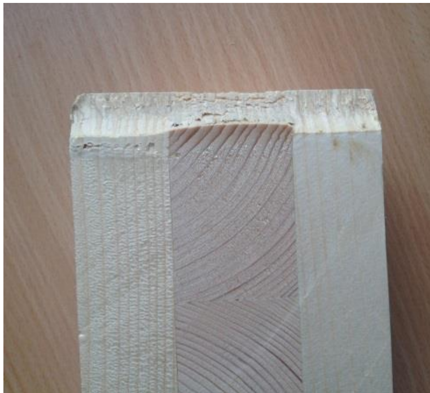
Joonis L6.1. 3-kihilise ristkihtpuidust katsekeha purunemispilt
