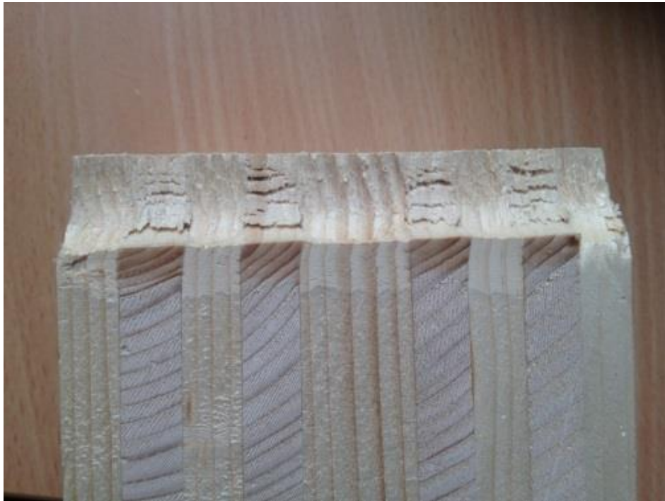
Joonis L6.3. 9-kihilise ristkihtpuidust katsekeha purunemispilt
