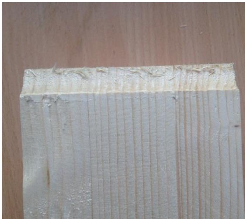
Joonis L6.2. 3-kihilise liimpuidust katsekeha purunemispilt
