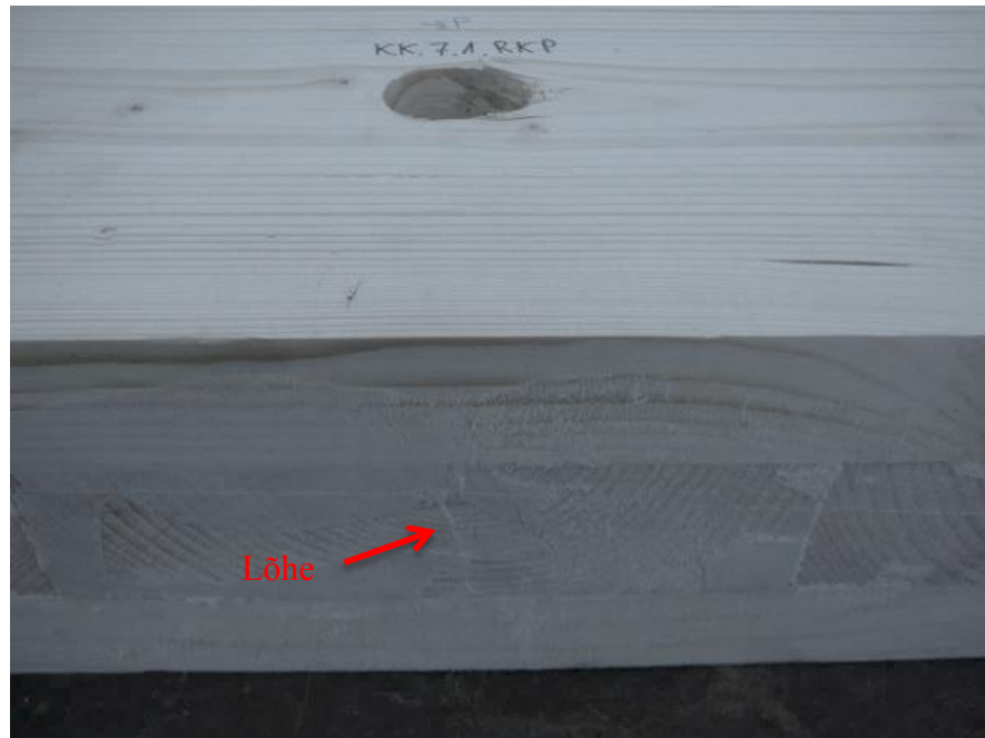
Joonis 3.24. Näide katsekehas risti paiknevas kihis kogu katsekeha laiuses väljaarenenud lõhest
