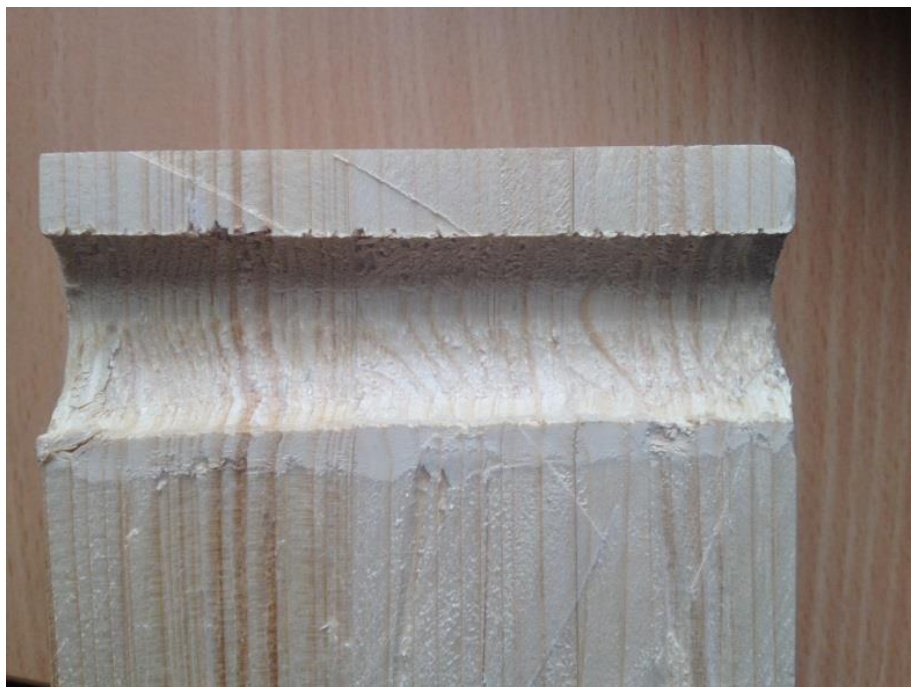
Joonis L6.4. 9-kihilise liimpuidust katsekeha purunemispilt
