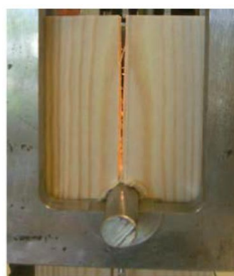
Joonis 1.22. Sileda naagli tüüpiline purunemispilt, kus vasakpoolne joonisel on katsekeha vahetult enne purunemist ja parempoolsel katsekeha vahetult pärast purunemist [31]
