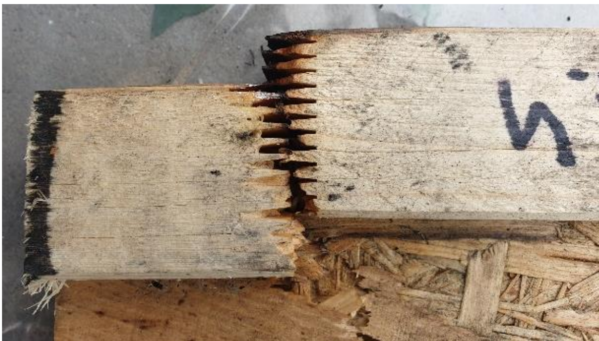
Joonis 29. Liimist purunenud vöö. [20]
