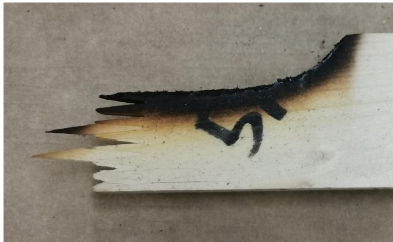
Joonis 21. Katsekeha purunemispildiga puit/liim.
