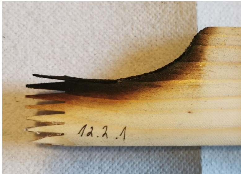
Joonis 20. Katsekeha purunemispildiga liim/puidukiud.
