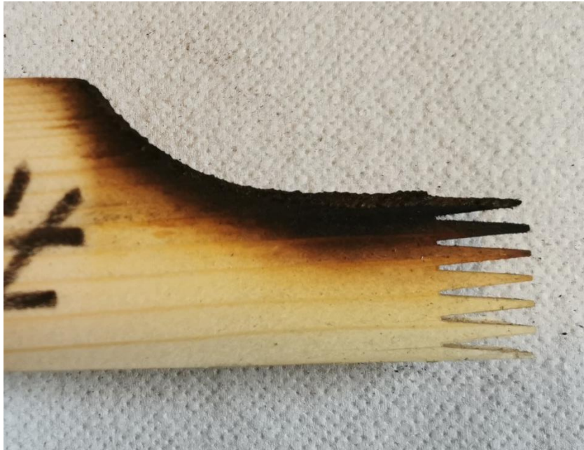
Joonis 18. Liimist purunenud katsekeha.
