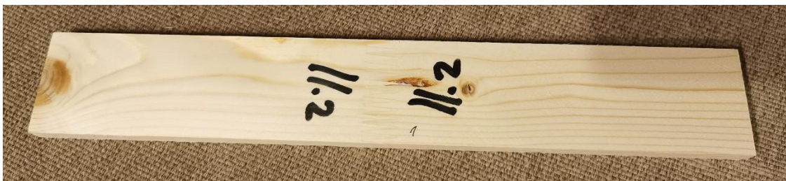
Joonis 24. Oksakohtadega katsekehad.
