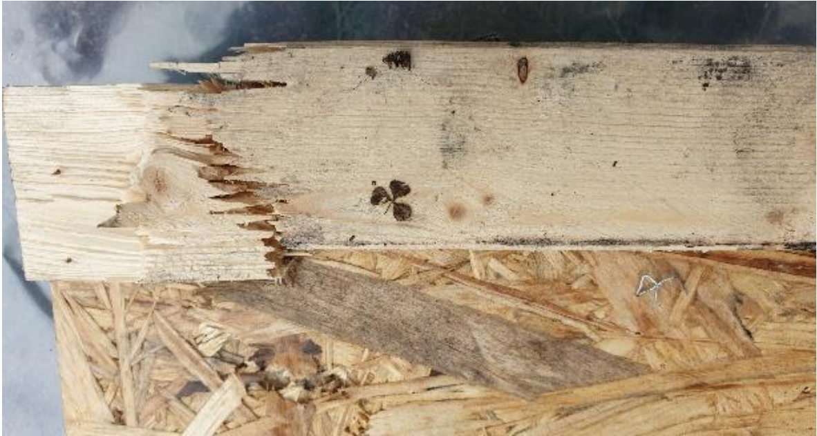
Joonis 30. Puidust purunenud vöö. [20]
