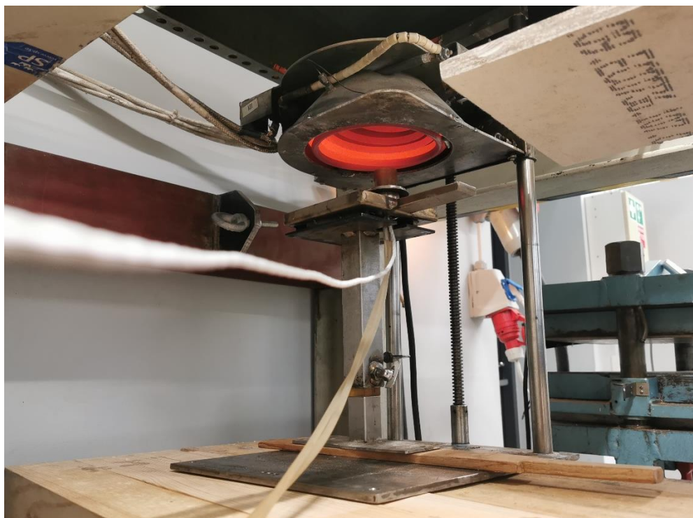
Joonis 11. Seade soojusvoo määramiseks.
