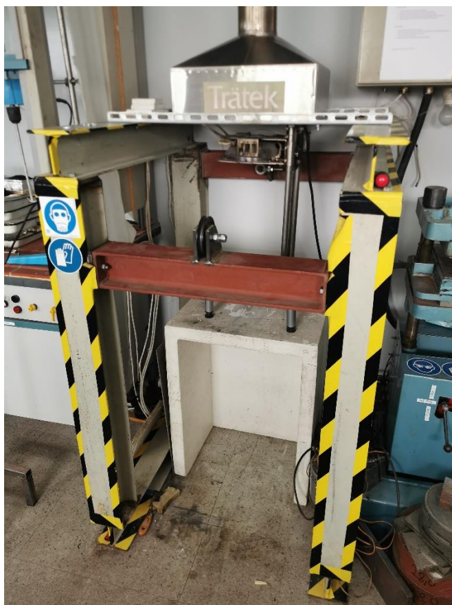
Joonis 10. Koonuskuumuti Tallinna Tehnikaülikooli Puidumaja laboris.
