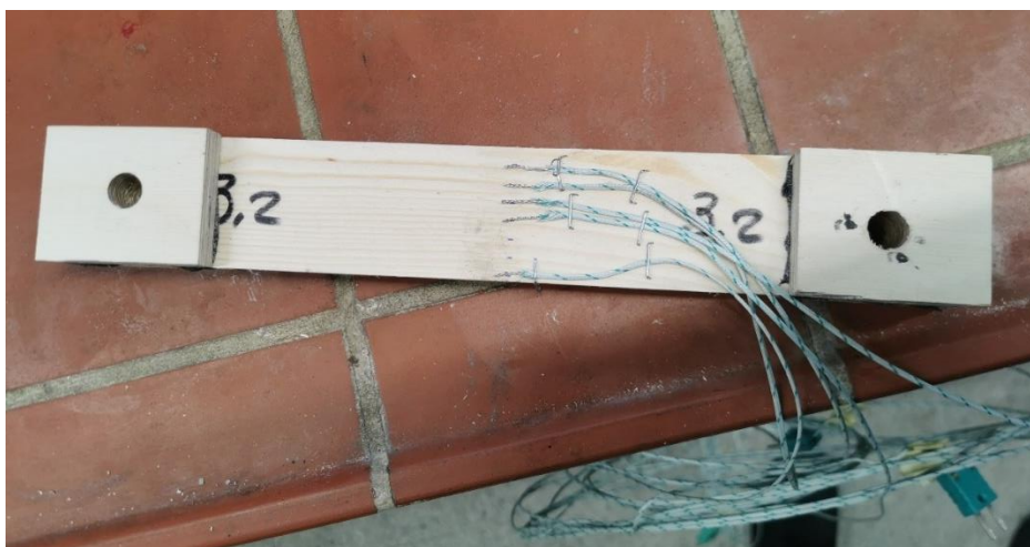
Joonis 16. Katsekeha temperatuurimõõdikute kinnitamine.
