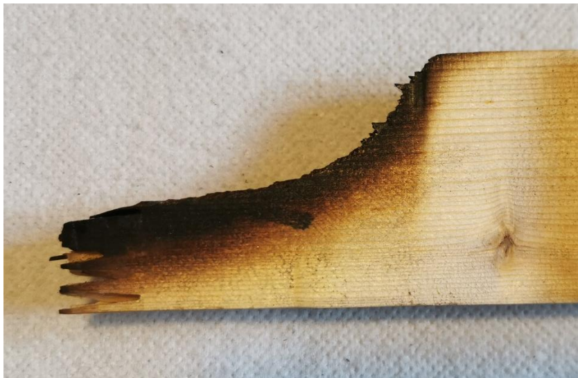
Joonis 19. Puidust purunenud katsekeha.
