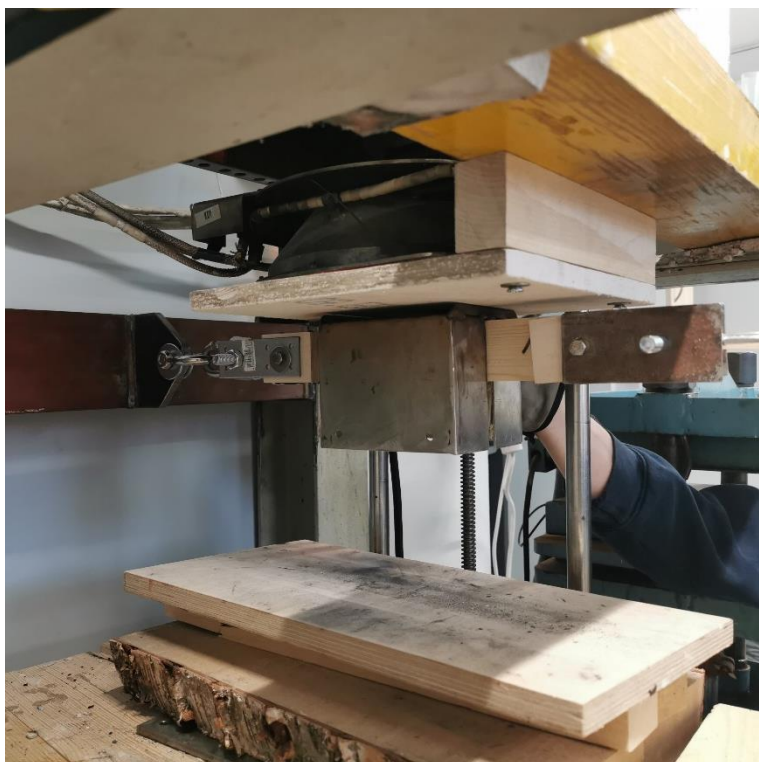
Joonis 14. Koonuskuumuti all olev keha vahetult enne katse algust.
