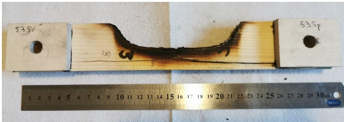
Joonis 17. Söest puhastatud katsekeha.
