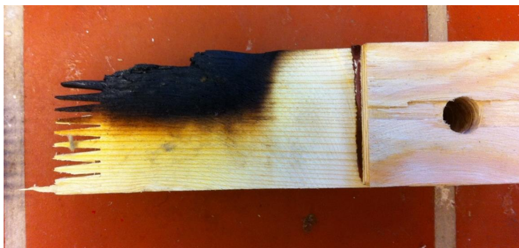
Joonis 15. Söestunud katsekeha näidis.
