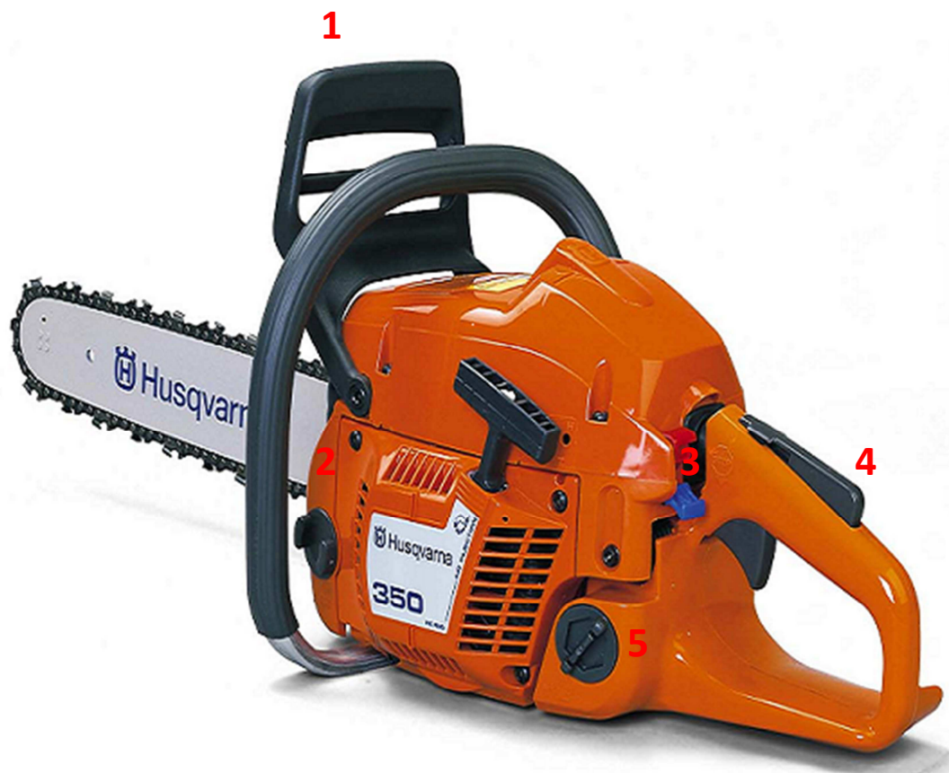
1-Ketipidur; 2-Ketiõlipaak; 3-Stopp- ja toorelüli; 4-Gaasilukustusseade; 5- Kütusepaak
