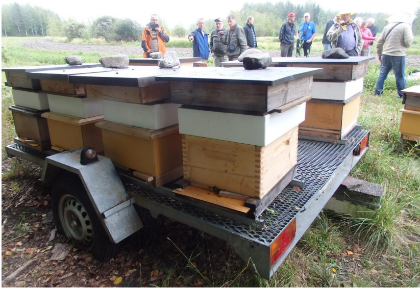
Käru-platvorm mesilasperede rände viimiseks.
