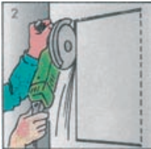
2. Lõigake ava ketaslõikuriga mööda kontuurjoont
