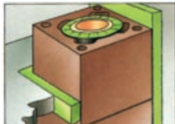
8. Fikseerige sadulühendus suitsulõõri avale, kasutades sideainena spetsiaalset (komplekti kuuluvat) kuumakindlat kleepesegu.
