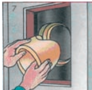
7. Kontrollige sadulühenduse sobivust suitsulõõrile sisselõigatud avaga.
