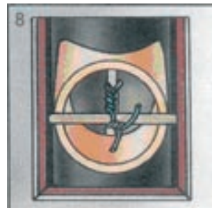
8. Fikseerige sadulühendus suitsulõõri avale, kasutades sideainena spetsiaalset (komplekti kuuluvat) kuumakindlat kleepesegu.
