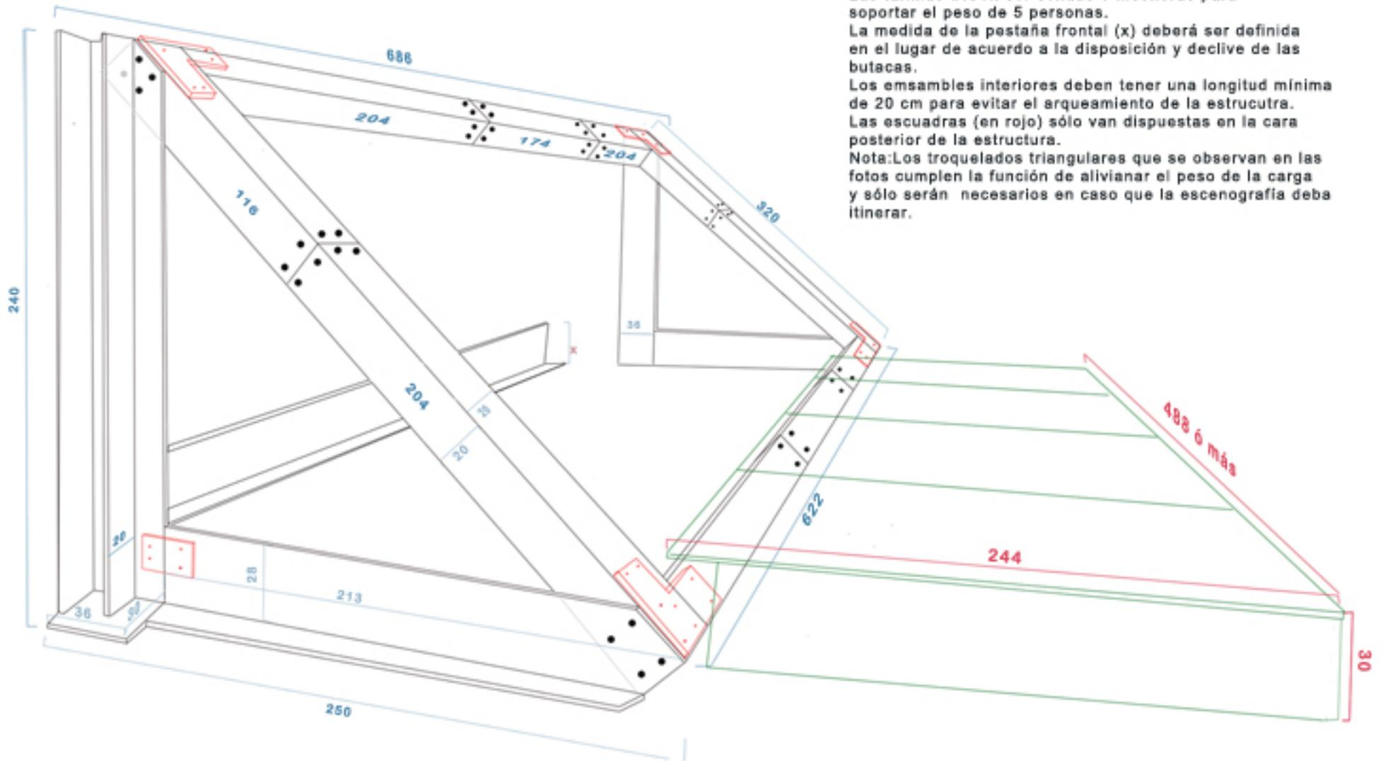
**Materiales:** Madera terciada espesor 15 mm (o más) para estructura y tarimas.
