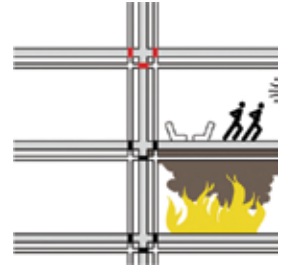
Kuva 35 Kaulus estää tulen ja savun leviämisen erillisestä huoneesta (120 minuuttia), joten ihmiset ehtivät poistua ja palokunta ehtii paikalle.
