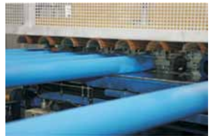
Valokuva 2. dBlue-putkia valmistetaan
