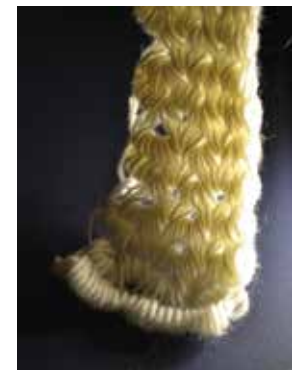
MultiWeave struktuur, pärast lõimetoetuste eemaldamist. The woven structure of Multiweave after removing the warp support.
