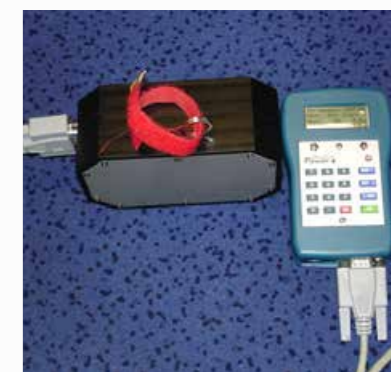
Foto 4. MicroMuscleLabi süsteemi mõõteandur ja mõõteplokk.
