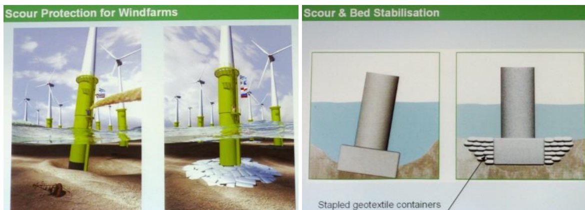
Joonis 151. Lehtrikujulised süvendid, mis on kujunenud tormitegevuse tulemusel merepõh-jale rajatud vundamendi postide ümber (Klompaker & Lenze, 2008)
