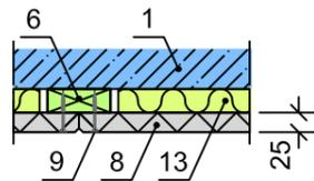
Befestigung der Montagelatte 80x30 mm direkt an der tragenden Konstruktion.
