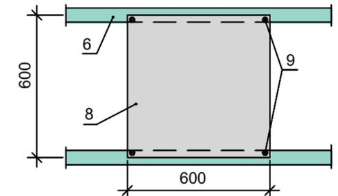
Befestigung von 600x600 Platten mit 4 Schrauben
