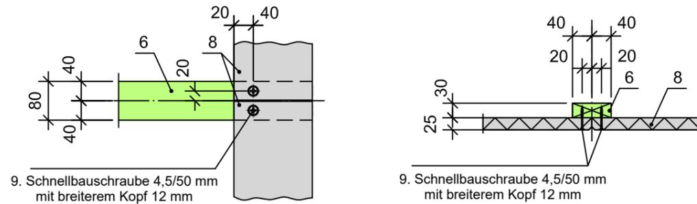
9. Schnellbauschraube 4,5/50 mm mit breiterem Kopf 12 mm
