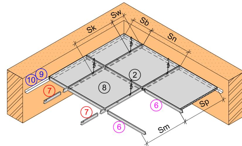
Die T-Profilrahmen für abgehängte Decken werden von einer Reihe von Herstellern angeboten. Der Deckenrahmen besteht aus vier Schlüsselementen:
