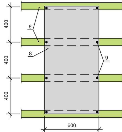
Befestigung von 600x1200 Platten mit 8 Schrauben
