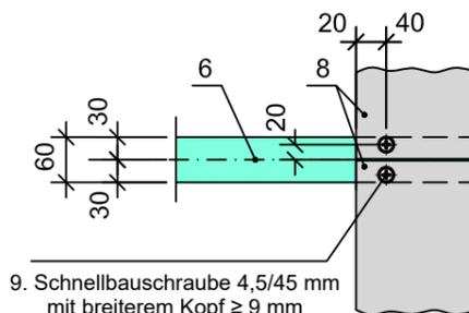
Die Verbindungsfuge wird immer unter dem CD-Montageprofil gebildet.
