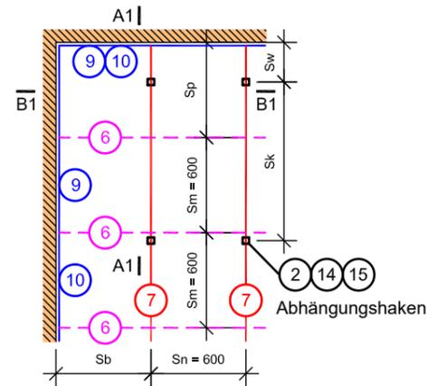
Profilanordnung für die Montage von 595x1195 mm Platten
