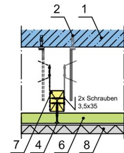
Längskantenstoß; Wechseln der Befestigungsstelle (Wechselnde Befestigung)
