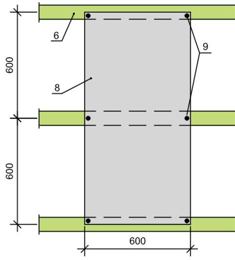
Befestigung von 600x1200 Platten mit 6 Schrauben
