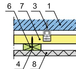
Stirnkantenstoß, Direktabhängiger 0,40 kN.
