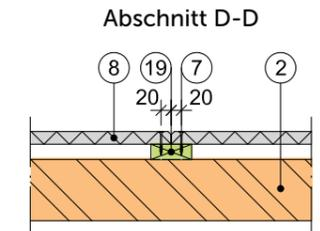
Befestigung von Holzlatten an der tragenden Wandkonstruktion
