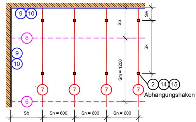
Profilanordnung für die Montage von 595x595 mm Platten
