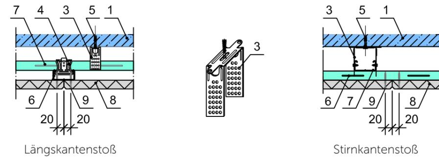
**Nr. 2. Schnellabhangung mit Anker für die Metallprofilrahmenkonstruktion**
