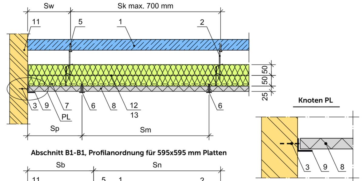
Abschnitt B1-B1, Profilanordnung für 595x595 mm Platten
