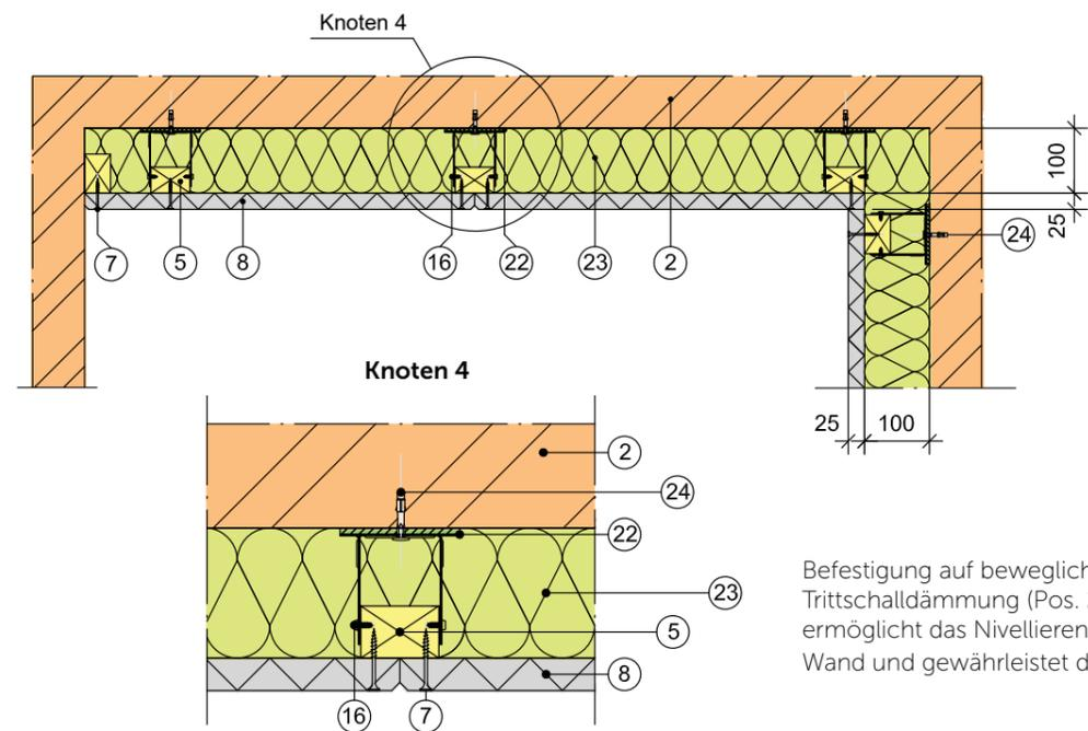
Befestigung auf beweglichem Untergrund und Trittschalldämmung (Pos. 22). Die Konstruktion ermöglicht das Nivellieren der vorhandenen Wand und gewährleistet die Trittschalldämmung.
