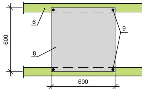
Befestigung von 600x600 Platten mit 4 Schrauben
