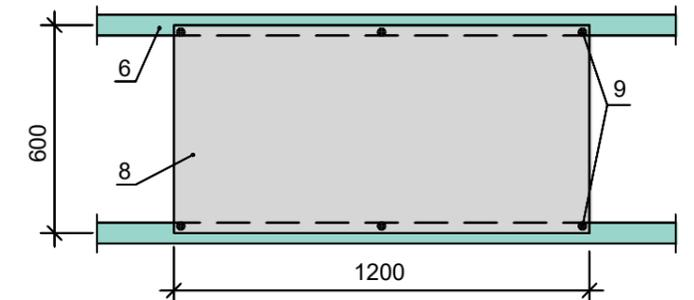
Befestigung von 600x1200 Platten mit 6 Schrauben in Längsrichtung
