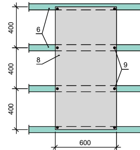
Befestigung von 600x1200 Platten mit 8 Schrauben
