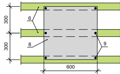
Befestigung von 600x600 Platten mit 6 Schrauben
