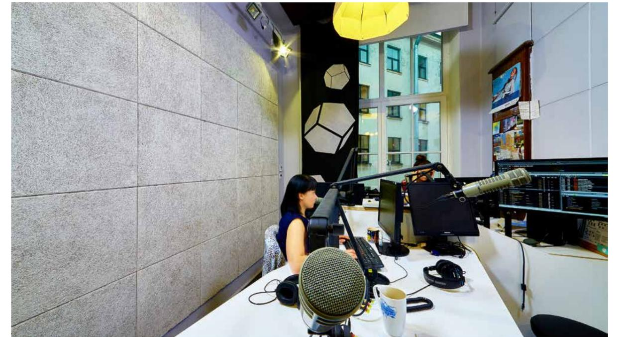
Akustikplatten sorgen für professionelle Schalldämmung mit maximaler Geräuschdämmung und reduzieren die Schallreflexion.
