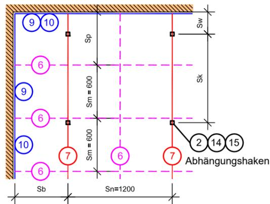
Profilanordnung für die Montage von 595x1195 mm Platten
