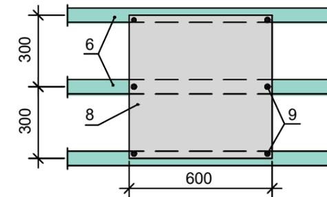
Befestigung von 600x600 Platten mit 6 Schrauben
