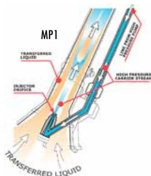
**Насосы HPW**, объединенные с недорогим инжектором, дает дополнительные возможности, такие как заполняющийся насос, множитель потока или взрыватель песка создают новые возможности для более эффективной работы.
