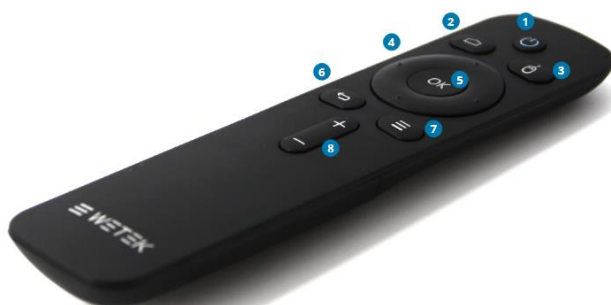
1. Sisse/väljalülitus, 2. Põhimenüüsse, 3. Hiirefunktsioon, 4. suunanupud, 5. ok/hiire parem nupp, 6. tagasi, 7. menüü, 8. helitugevus
