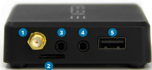
1. Antenn, 2. mälukaardi pesa, 3. programmeerimine, 4. puldisignaali vastuvõtja, 5. USB ühenduspesa
