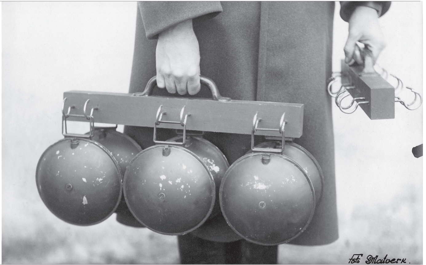
Tankitõrjemiinide TM/34 kandmine kandepuuga
