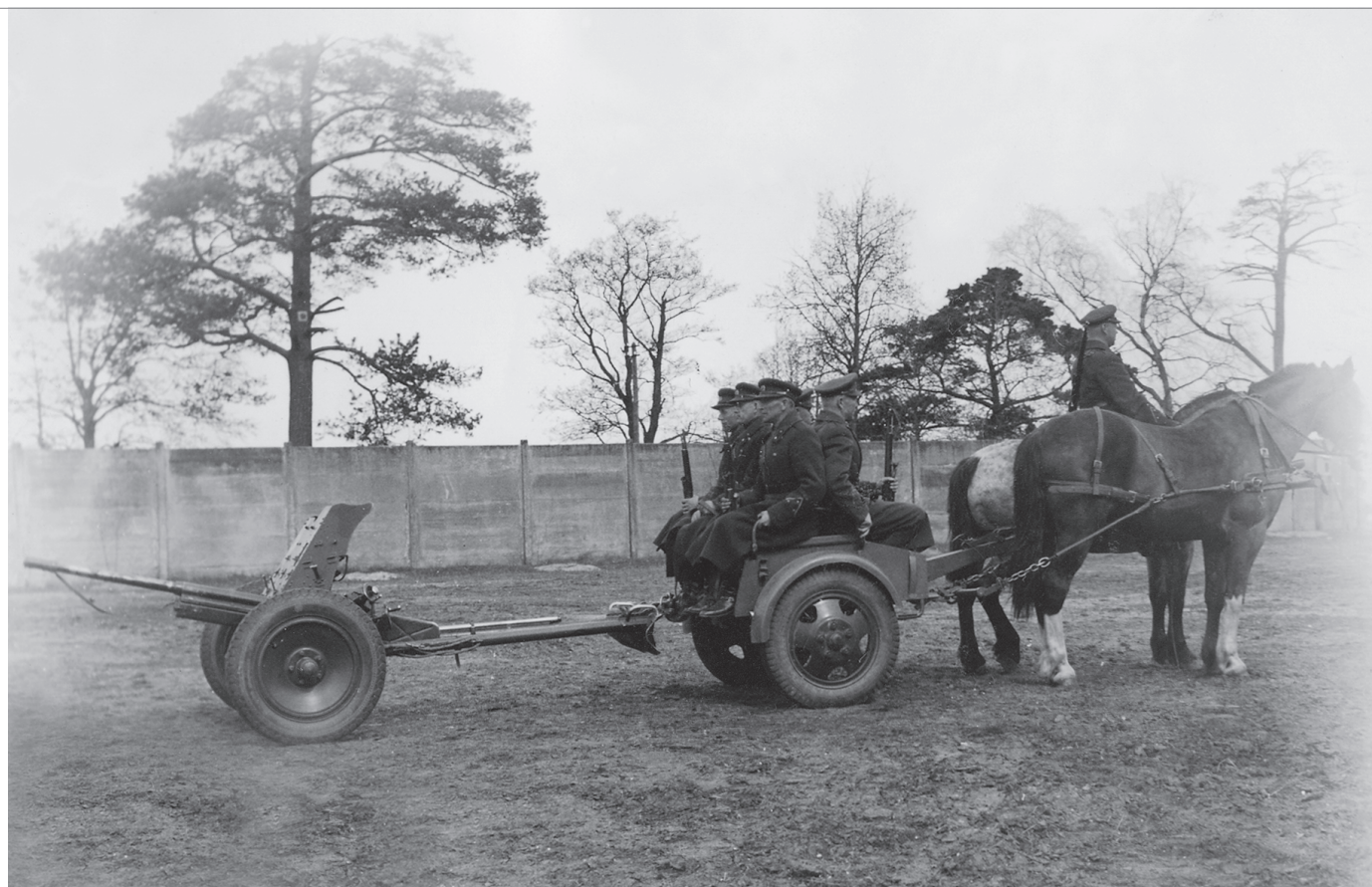
Rheinmetalli 37-mm tankitõrjekahur Eestis konstrueeritud eelikuga Tondil
