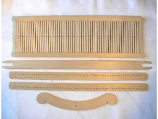
Abivahendid tihvaga kudumiseks; tihv, süstik, otsalauad.
