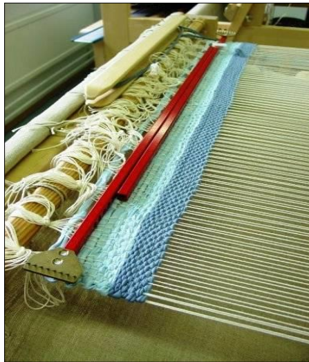
Joonis 1. Vabastatud kangapinguti.
