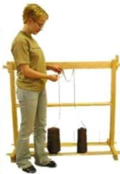
Joonis 1-3. Rulliraam ja käärlaud. Poolid poolihoidikus. Algsõlm.
