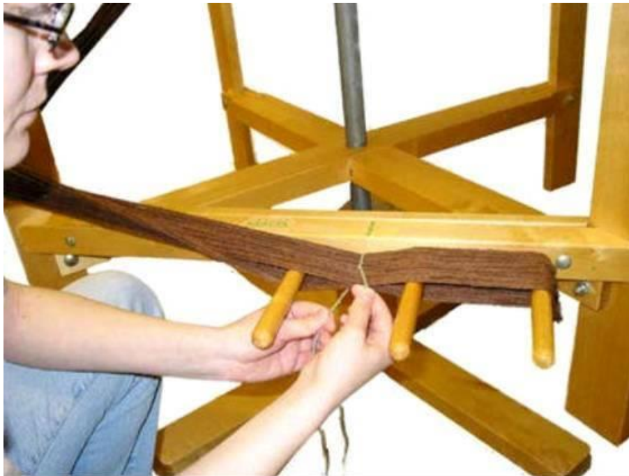
Joonis 11. Lõngade loendamine pasmanööri abil.
