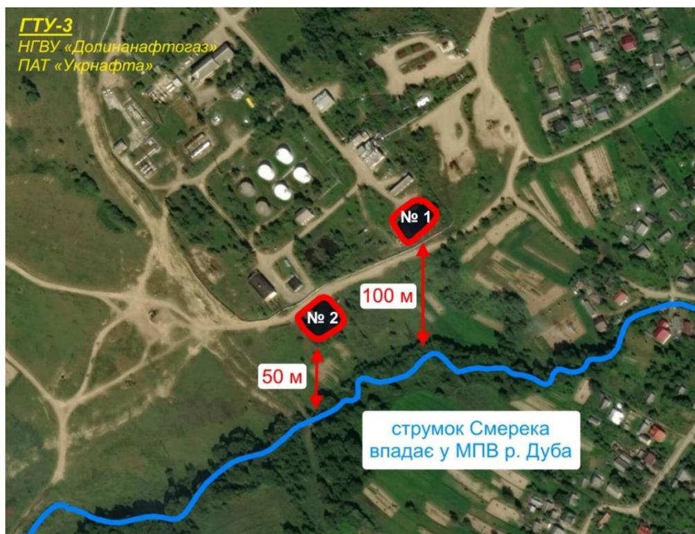
Рисунок 32. Розташування шламових амбарів ГТУ-3 по відношенню до гідрографічної мережі
