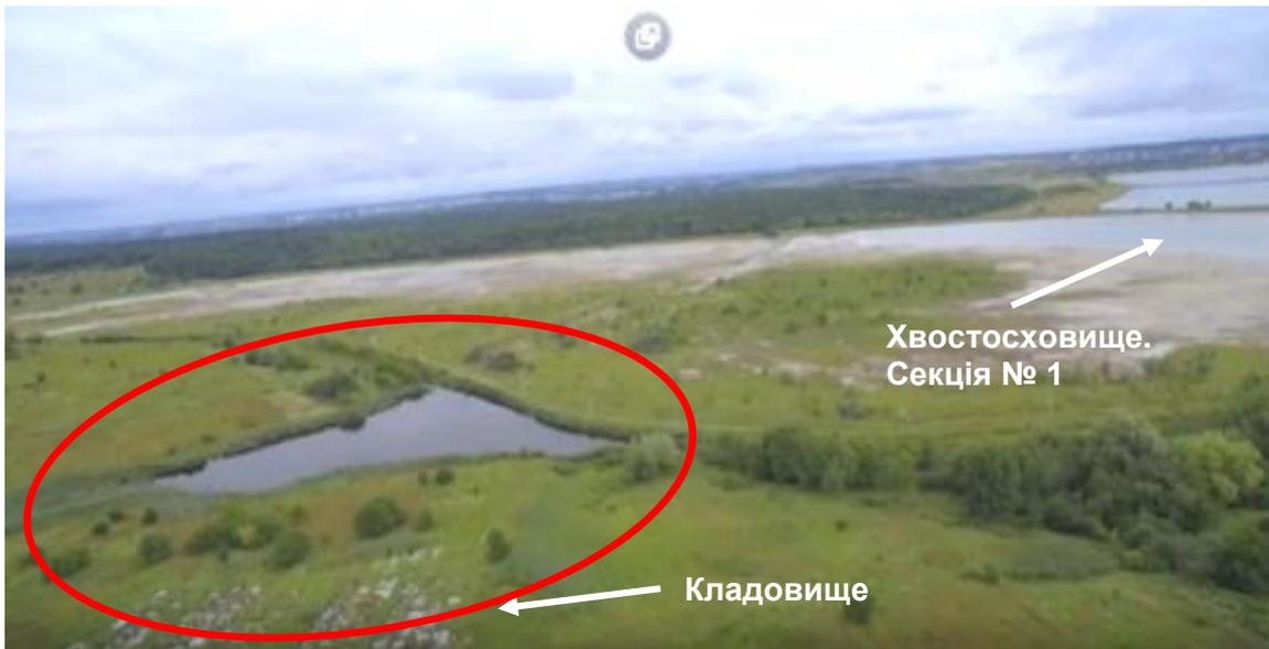
Рисунок 67. Аерофотозйомка. Ознаки підтоплення поряд з секцією № 1 хвостосховища
