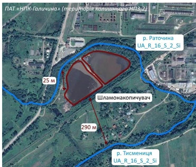
Рисунок 73. Розташування шламонакопичувача НПЗ-2 ПАТ «НПК-ГАЛИЧИНА» по відношенню до гідрографічної мережі
