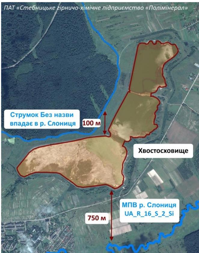
Рисунок 63. Розташування хвостосховища по відношенню до гідрографічної мережі
