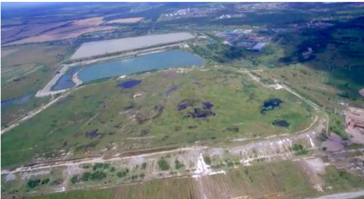
*Рисунок 8. Аерофотознімок району розташування хвостосховищ, найближче на знімку – хвостосховище № 1, потім – хвостосховище № 3 та № 2*
