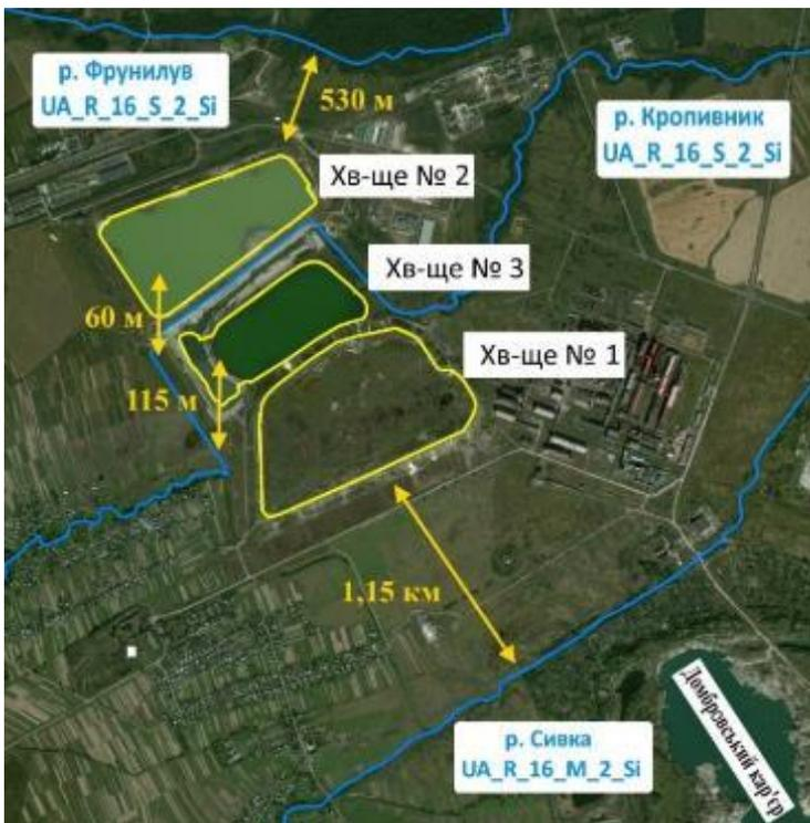
Рисунок 7. Розташування хвостосховищ ТОВ «Оріана-ЕКО» по відношенню до гідрографічної мережі
