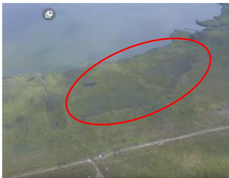
Рисунок 56. Аэрофотоснимок. Признаки подтопления территории возле хвостохранилища № 2
