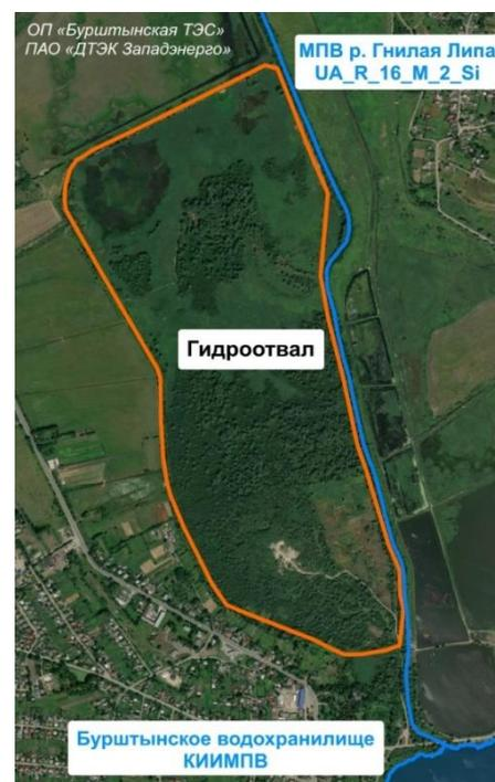
Рисунок 47. Расположение гидроотвала по отношению к гидрографической сети
