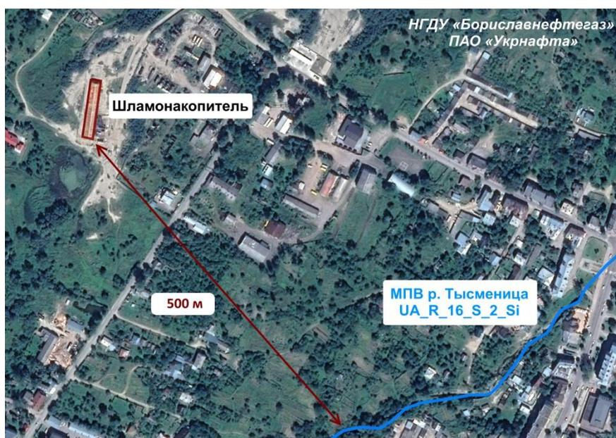
Рисунок 74. Расположение шламонакопителя НГДУ «Бориславнефтегаз» по отношению к гидрографической сети
