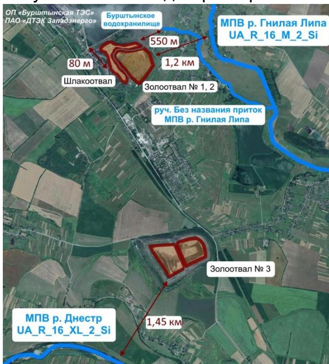
Рисунок 46. Расположение золоотвалов и шлакоотвала по отношению к гидрографической сети
