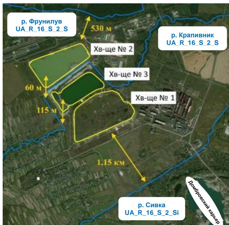
Рисунок 7. Расположение хвостохранилищ ООО «Ориана-ЭКО» по отношению к гидрографической сети
