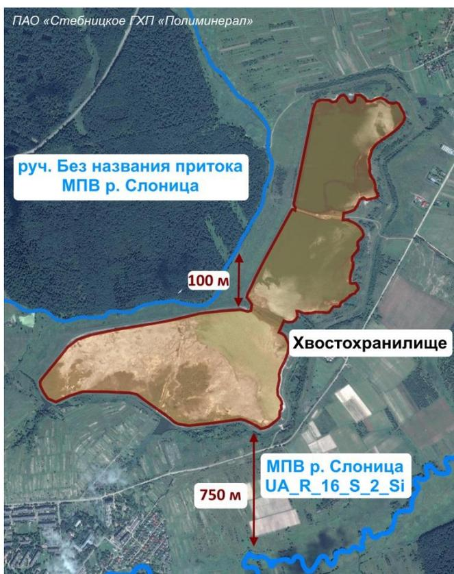
Рисунок 63. Расположение хвостохранилища по отношению к гидрографической сети
