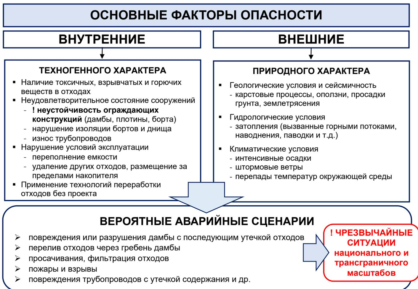
Рисунок 6. Основные факторы опасности при эксплуатации хвостохранилищ<sup>24</sup>
