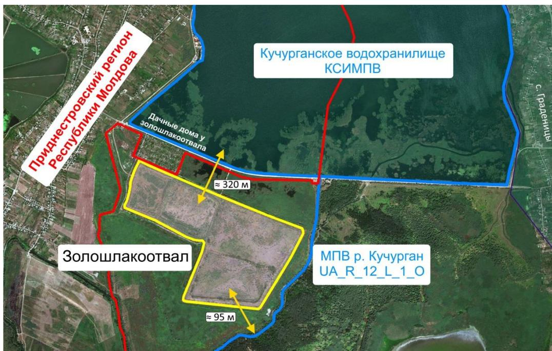
Рисунок 80. Расположение золошлакоотвала Молдавской ГРЭС по отношению к гидрографической сети
