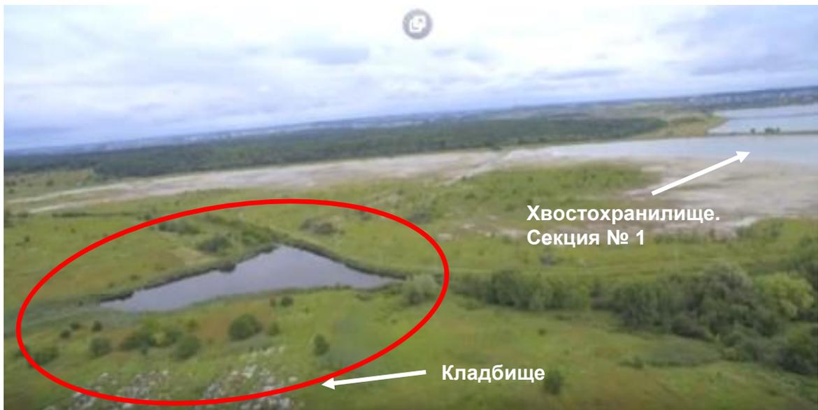
Рисунок 67. Аэрофотосъемка. Признаки подтопления рядом с секцией № 1 хвостохранилища
