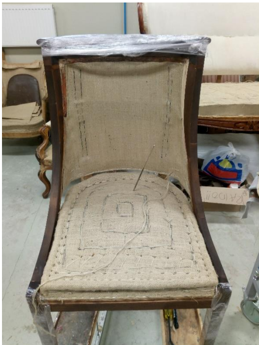
Kandi õmblemine- 3 esikant. Lisaks on tooli seljatoele paigaldatud kotiriie, millele paigaldatakse merihein.
