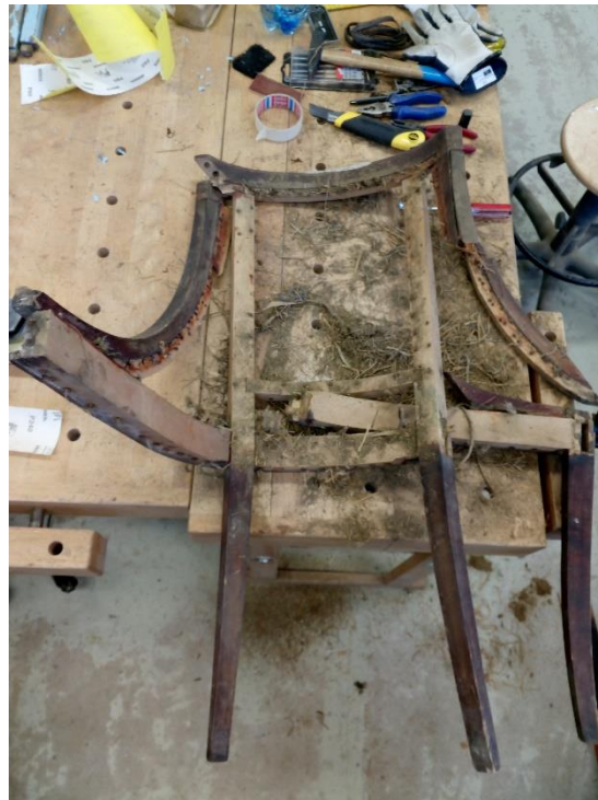
Polstrid on eemaldatud. Vaade tooli raamile.
