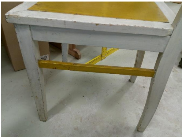
Vaade toolii parempoolsele sidepulgale. Sidepulga ja tagumise jala tappühendus on lahti.
