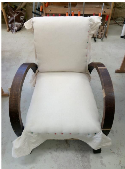
Ühe tooli vaheriie on nõeltega paika pingutatud. On viimane aega proovida tugitooli raamile (eriti oluline on sobivus käetugede vahele)
