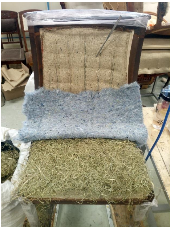
Vahekihi- meriheina ja vati paigaldamine enne vaheriide paigaldamist.
