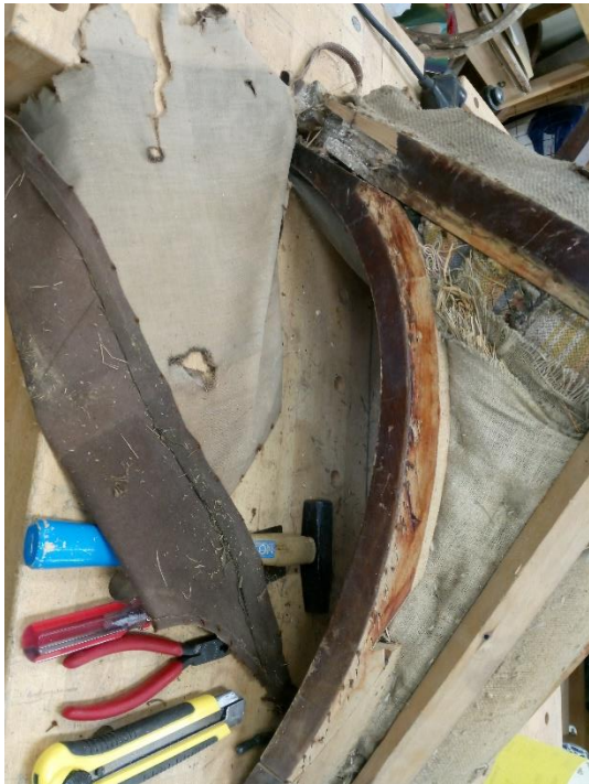
Tools osandamine. Polstri eemaldamine.
