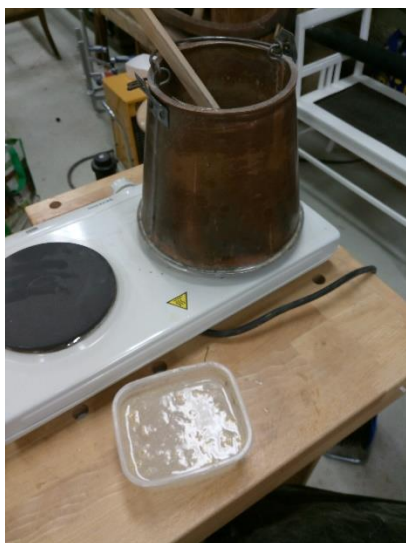
Kondiliimi kuumutamise nõu.
