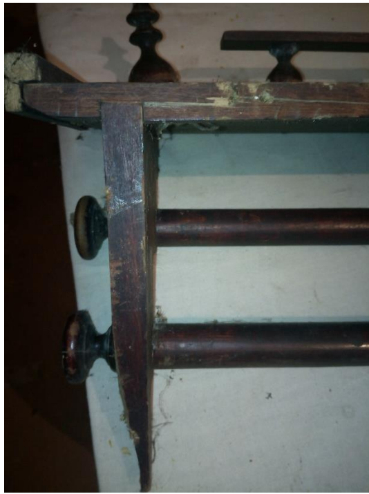
Lähivaade- puudub riputi. Näha puidukadusid ja pikisoonelisi pragusid.
