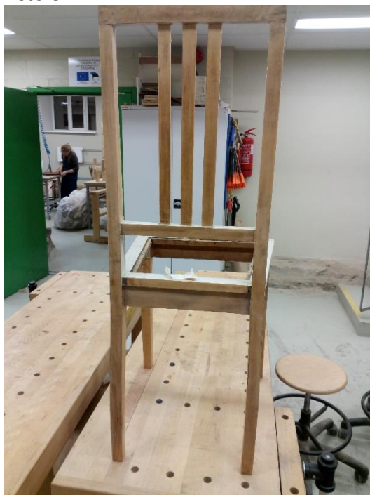
Värvist puhastatud tooliraam
