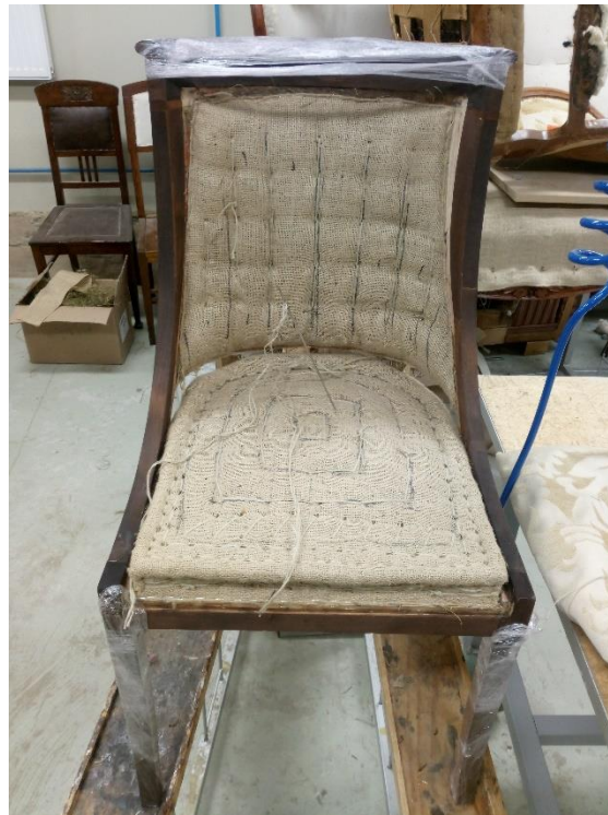
Merihein on kaetud kotiriidega, mis on läbi õmmeldud.
