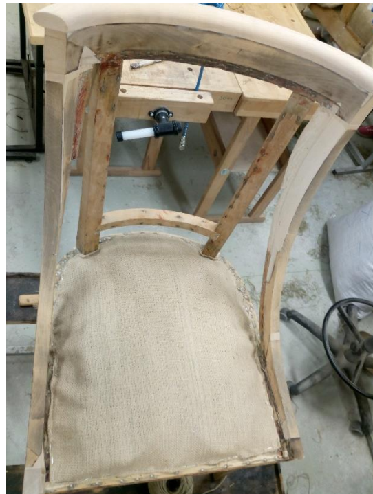
Vedrupeale on paigaldatud paks kotiriie. Kotiriie õmmeldakse vedrude külge ( neli õmblust per vedru ) ja tihiniit, mis hoiab meriheina paigas kuni polster saab lõplikult läbi õmmeldud.
