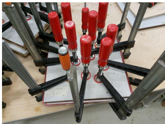
Liimitud detail on paigutatud pitskruvide abil pressi alla.
