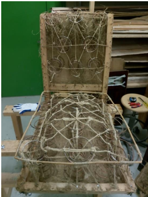
Seljatoe ja istme vedrude katteriided on eemaldatud.
