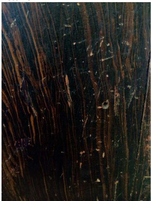
Mehaanilised kahjustused Kapi seinal enne retušeerimist.
