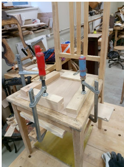
Toolipõhi on liimitud, paigutatud raami sisse ja kuivab pressi all.
