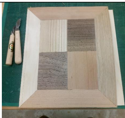
Vaade spoonilõike liimitavale pinnale. Raamil on näha aluspinna paigaldamiseks vajalikud abijooned
