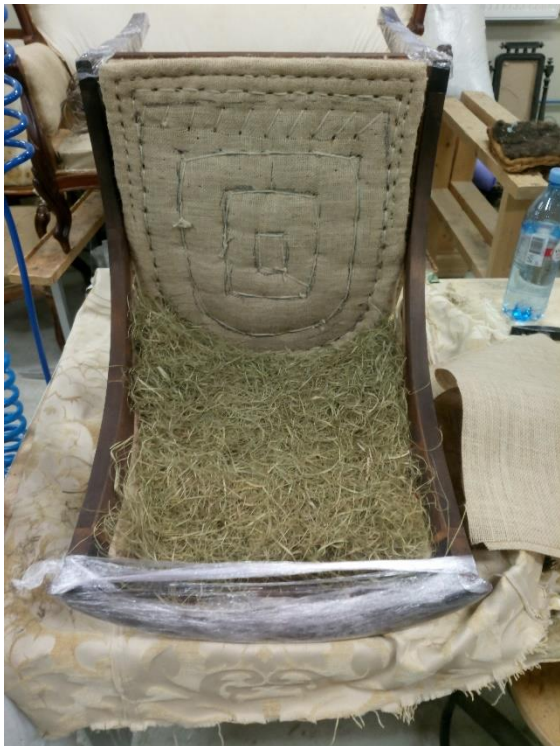
Seljatoele on laiali laotatud merihein.
