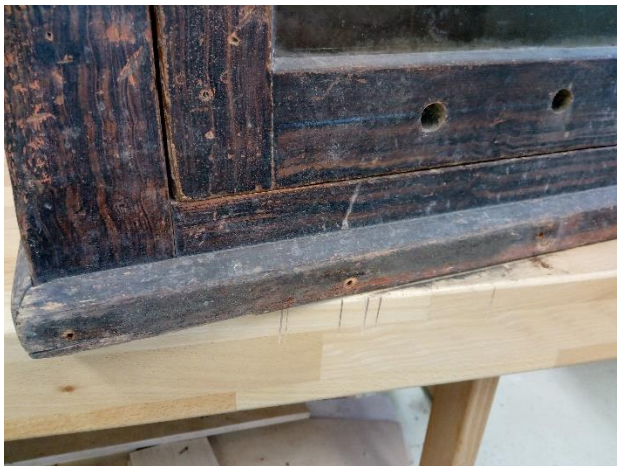
Mõigasservale kinnitatud vineer on eemaldatud.
