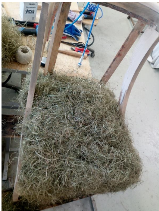
Merihein on paigaldatud tihiniidi vahele.
