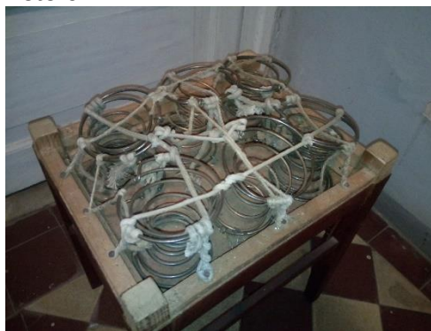
Vaade sellele, milline on olnud materjalide kasutus vedrude sidumisel.
