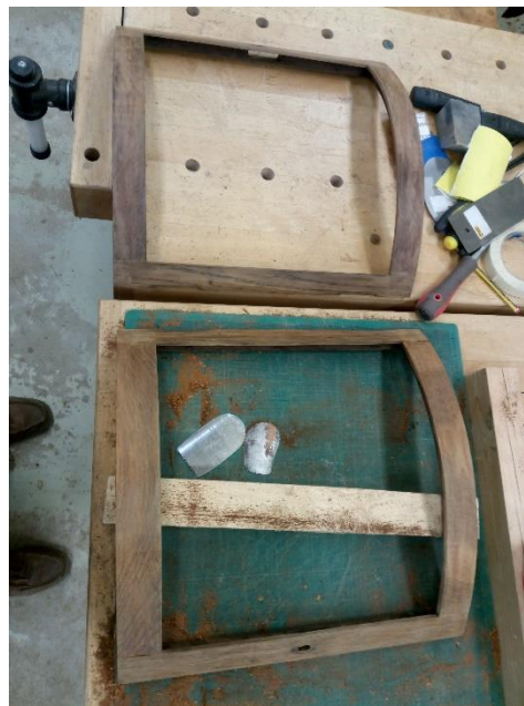
Vitriini külgmiste kumerate uste raamid on puhastatud
