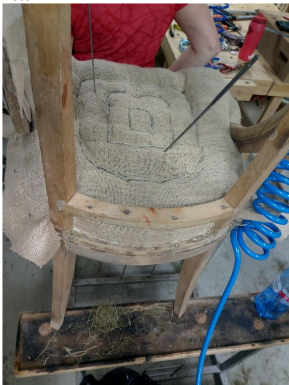
Kotiriide ääre kinnitamisega on alustatud tooli seljatoe poolt.
