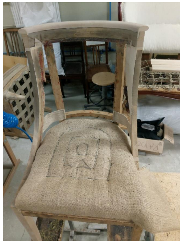
Kotiriide kinnitamine saride külge on lõpusirgel. Kiinitada on jäänud veel tooli parempoolne esimene nurk.
