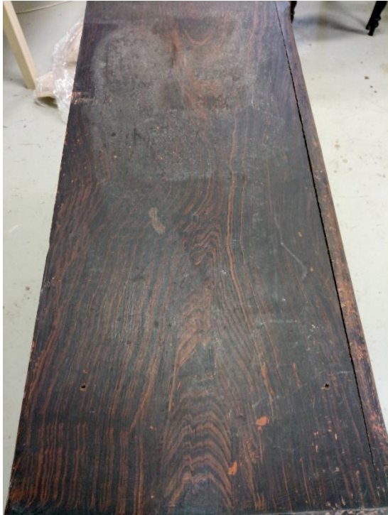
Vaade kapi küljele. Foto alumises osas näha mehaanilisi kahjustusi, riibitud aaderdust. Foto ülemises osas näha halle laike (mis ei ole hallitus).
