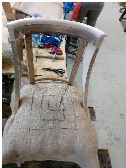
Meriheinalale on paigaldatud hõre kotiriie. Riie on pingule tõmmatud saride külge löödud polstrinaelte taha. Riidele on peale joonistatud abijooned polstri läbiõmblemiseks.
