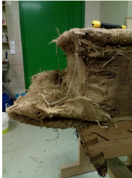
Tooli istme ette õmmeldud „tasku“, mis on raami kumeruse pikenduseks ja mis õmmeldakse ning täidetakse selliselt, järgiks käetugede kuju.
