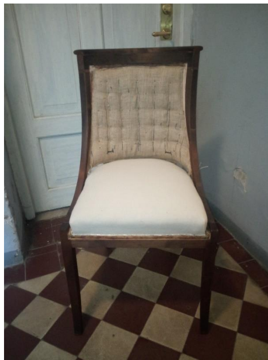
Istme vaheriie on kinnitatud. Ennem seljatoe vahekihi ja vaheriide paigaldamist toimub raami lakkimine.
