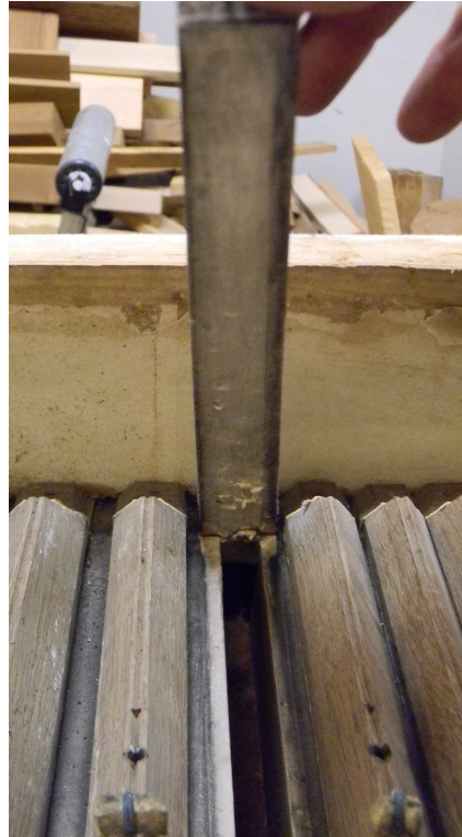
Manuaalventiili kulunud nahk.
