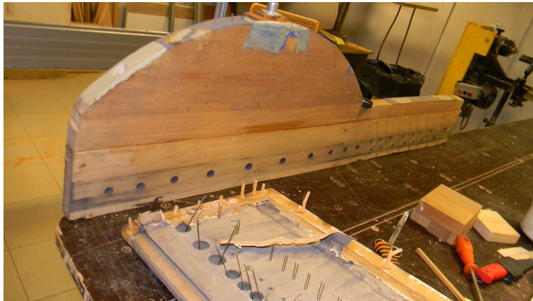
Pr..8' vilepõhi ja ventiilikasti põhi koos läbiviikudega.
