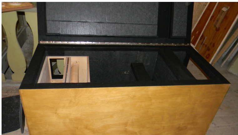
Uus ventilaatori summutuskast koos regulaatoriga.
