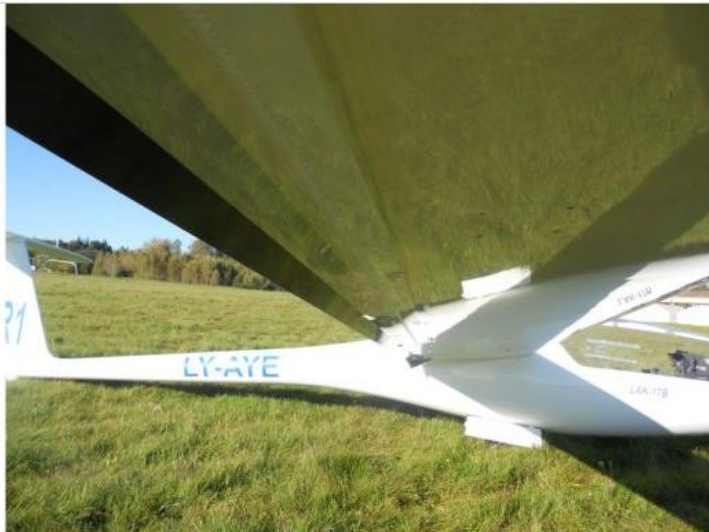
Die Miniklappen fahren aus den Flaperons der LAK-17b aus. Foto und Copyright: Estonian Aviation Academy
