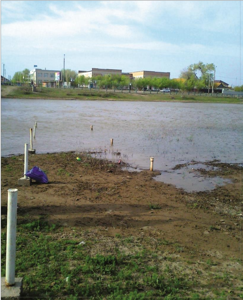
EL abiprojekti toel rajatud Kigatši jõe hüdromeetriaajaama mõõtelävend. Foto: Serik Ahmetov.
