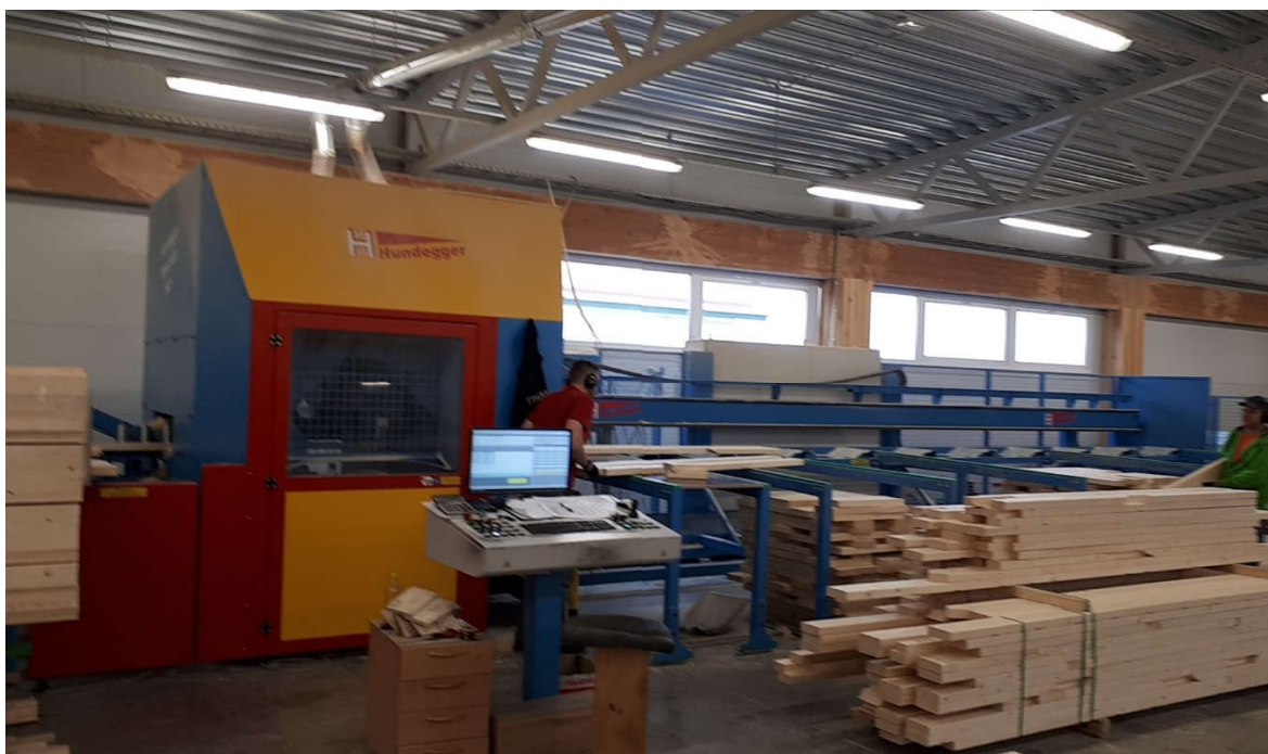
Joonis 3.12. Hundegger Speed-Cut automaatne CNC töötlemispink (H. Laidla foto 2019).
