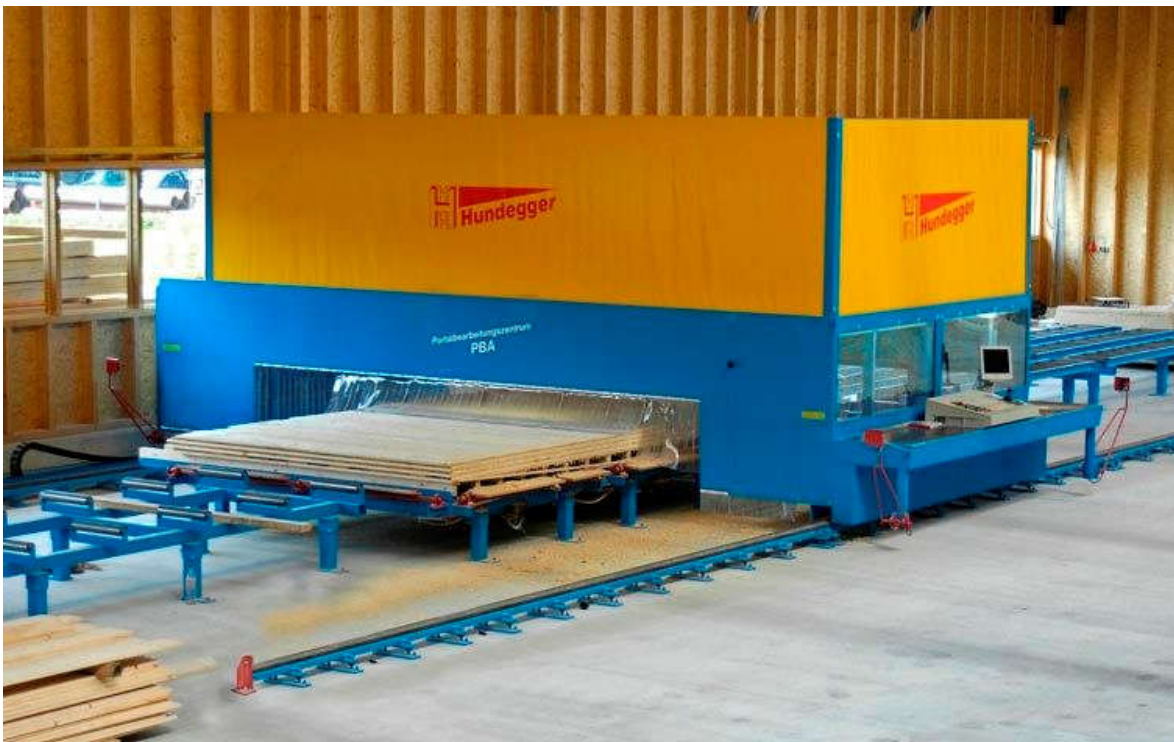
Joonis 3.12. Hundegger PBA paneeli töötluspink, mis suudab suurte liikumisteede tõttu töödelda mistahes pikkusega, kuni 8 m laiuseid ja 48 cm paksuseid paneele.
