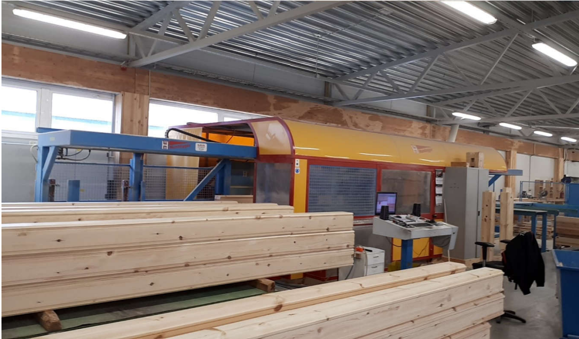
Joonis 3.13. Hundegger K2 automaatne CNC töötlemispink (H. Laidla foto 2019)
