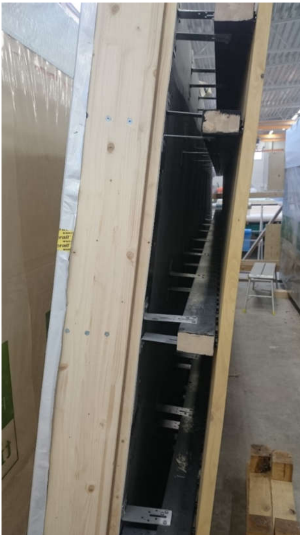
Joonis 3.19. Tootmises valminud näidis välisseina element (K.Koitla foto 2017).
