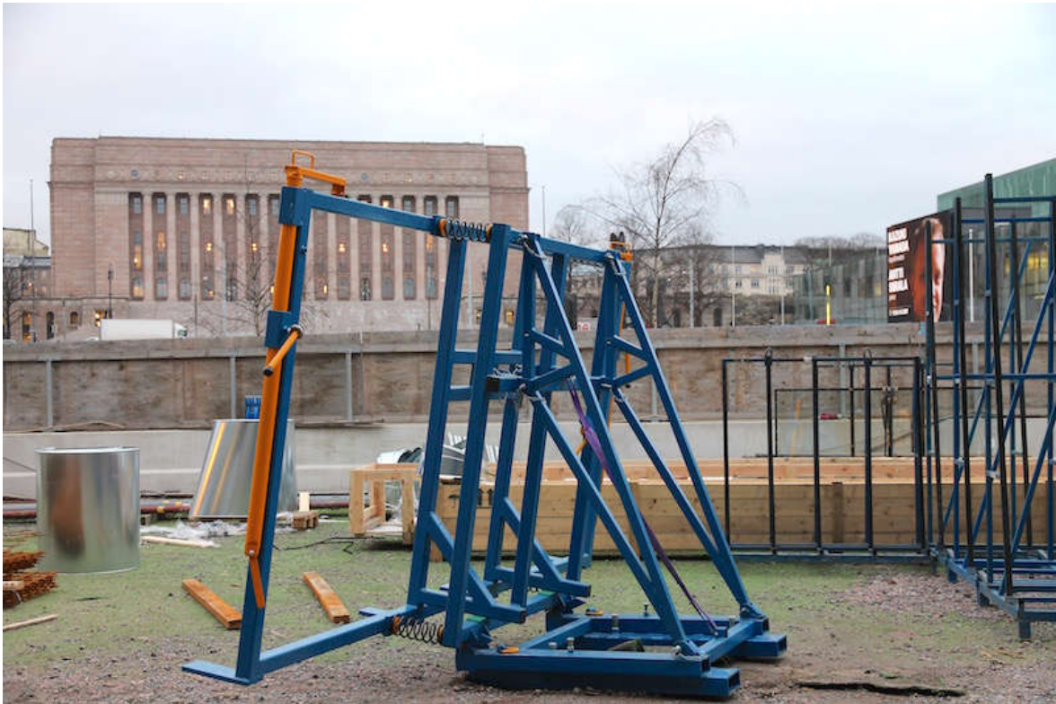
Joonis 3.22. Kinnitatav rakis teleskooplaaduri kahvli otsa kumera fassaadiseina elementide paigaldamiseks (T. Urva foto 2018).
