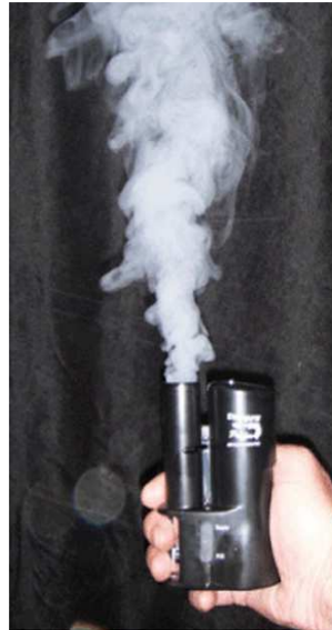
Joonis 3.4 Õhuvooluindikaator Dragon Puffer ( http://www.zerotoys.com ).
