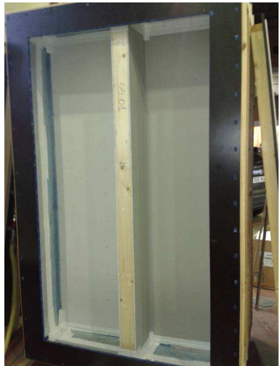
Joonis 3.17 Välissein + sisesein vannituba kohal (VSVA) katsekambris.
