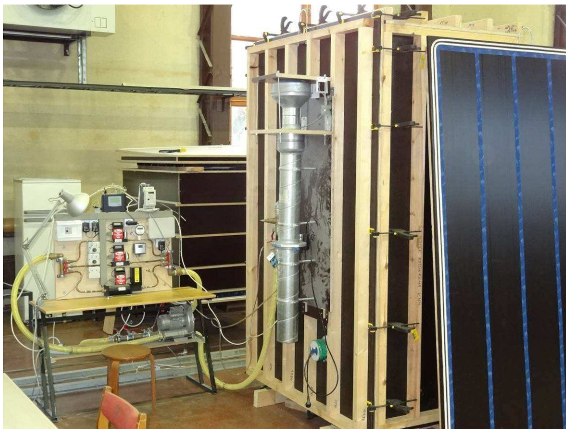
Joonis 3.2 Õhulekke mõõtekamber TTÜ laboris (Kalamees jt, 2015).
