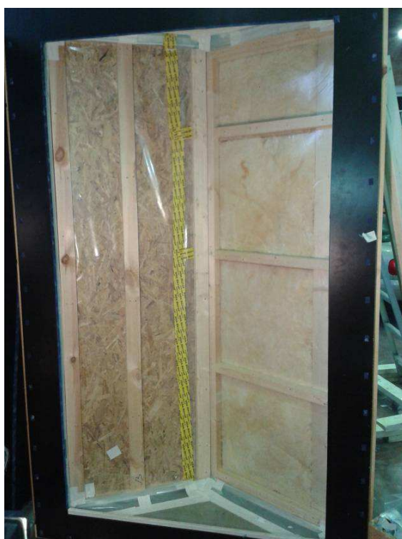
Joonis 3.20 Välisseina ja katuse liitekoht (VSKE) katsekambris.
