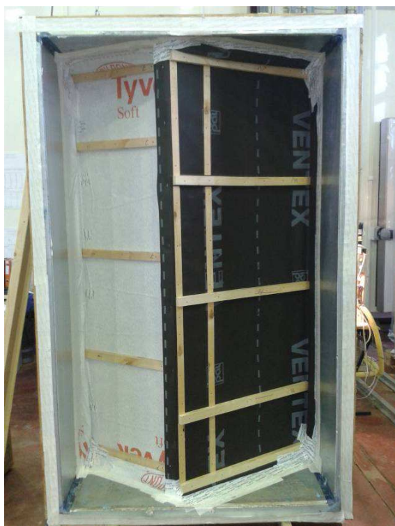
Joonis 3.20 Välisseina ja katuse liitekoht (VSKE) katsekambris.
