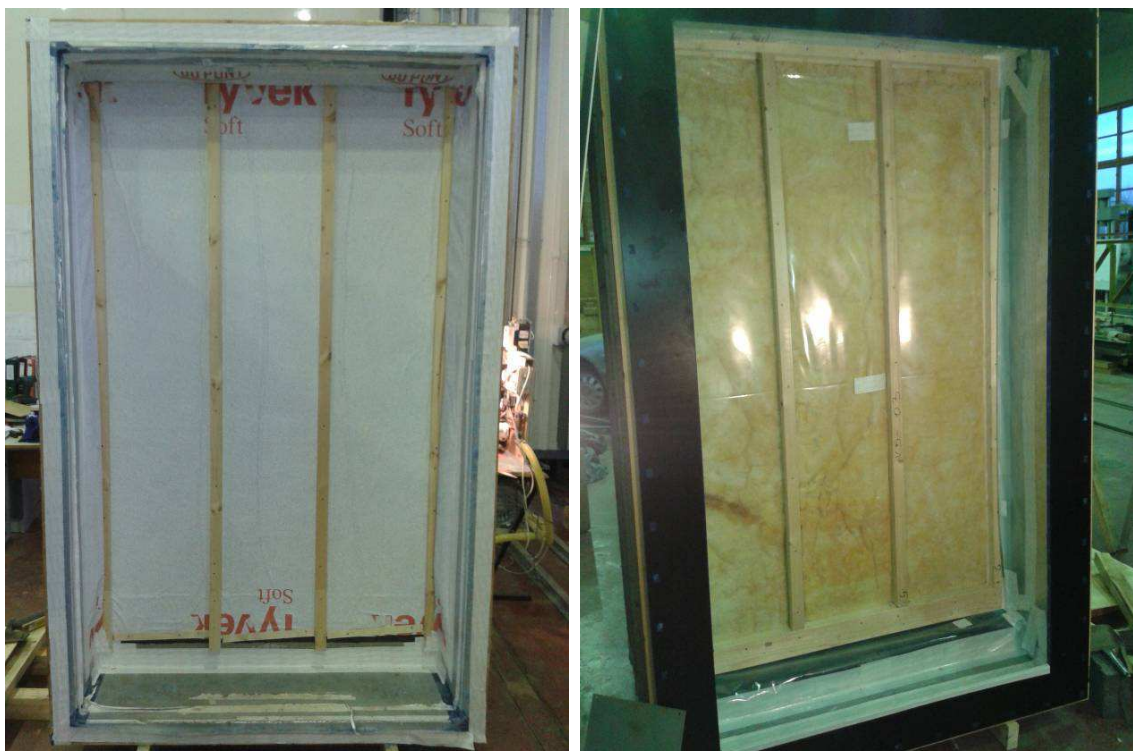
Joonis 3.9 Välisseina ja sokli liitekoht (VSVU) katsekambris.
