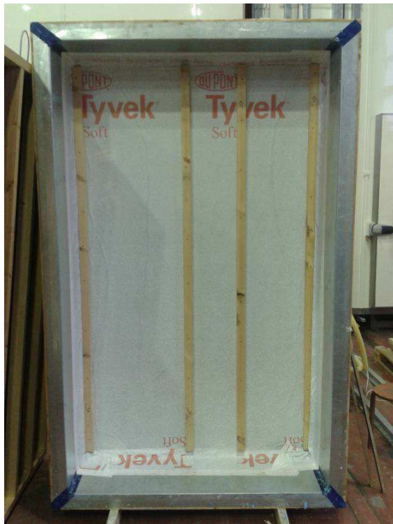
Joonis 3.17 Välissein + sisesein vannituba kohal (VSVA) katsekambris.
