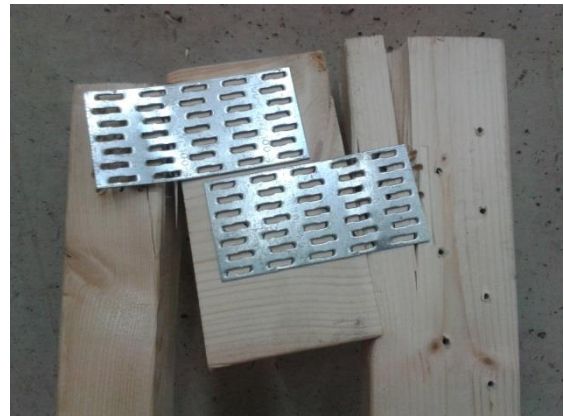
Joonis L5.22. Kartro post 5 purunemispilt 2
