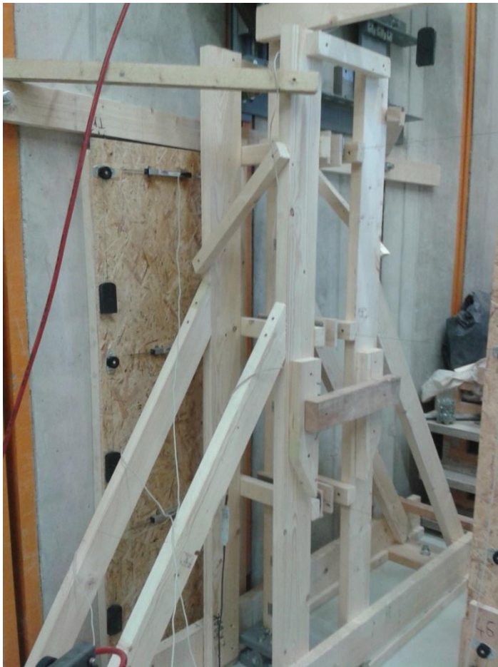
Joonis 3.12. Ajutine konstruktsioon, et vältida sõrestikposti y-telje suunalist nõtkumist.
