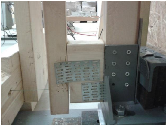
Joonis L5.21. Kartro post 5 purunemispilt 1
