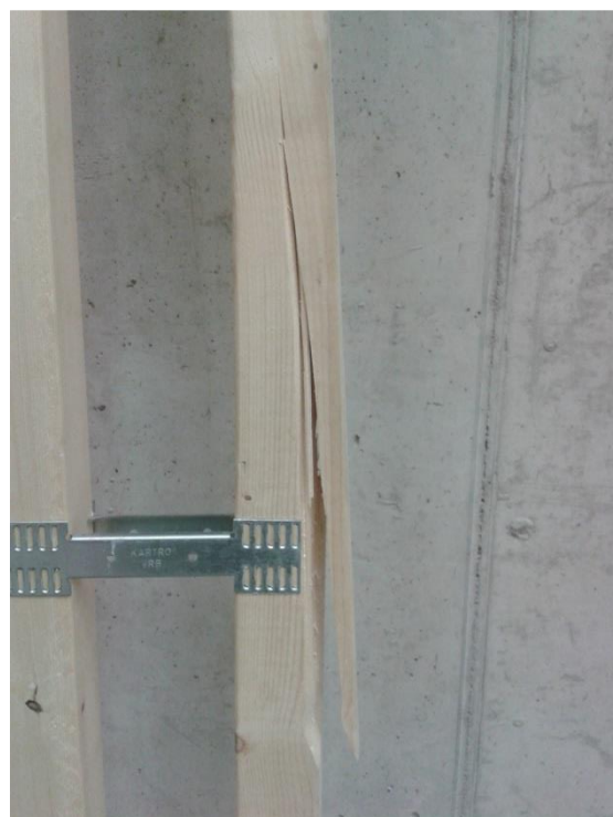
Joonis L5.4. Kartro post 2 purunemispilt 2
