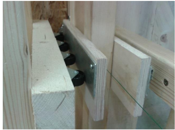
Joonis 3.11. Toed y-telje suunalise nõtkete vältimiseks
