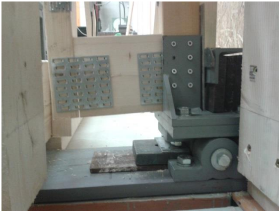
Joonis 3.10. Alumine kinnistugi
