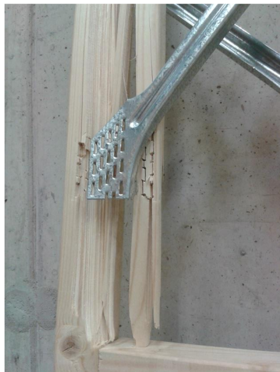
Joonis L5.26. Posi post 4 purunemispilt 2
