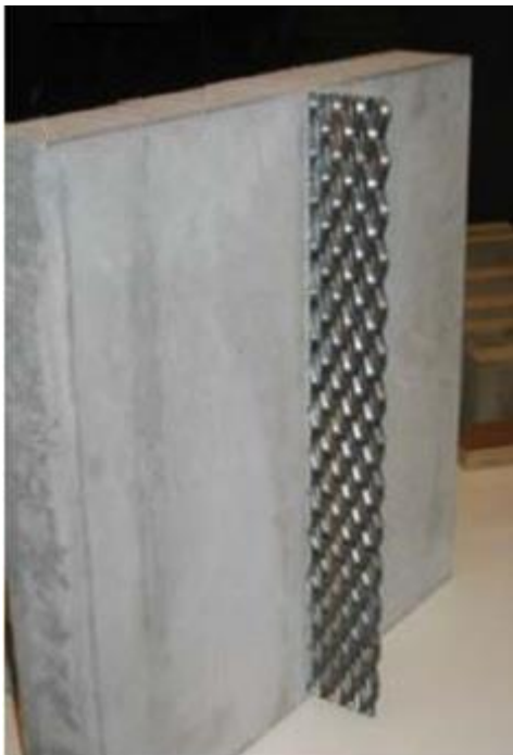
Joonis 1.4. Betoonplaati kinnitatud SM terasvõrk (Lukaszewska et al. 2006)
