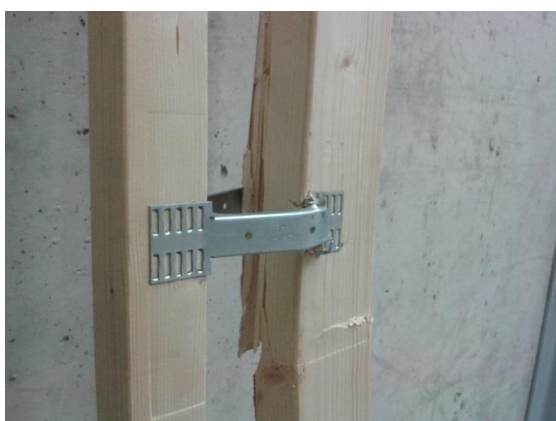
Joonis L5.5. Kartro post 3 purunemispilt 1
