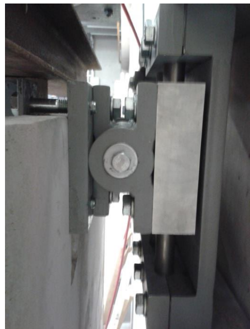
Joonis 3.9. Ülemine liikuv-liigendtugi
