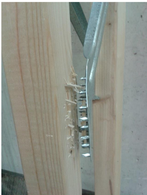
Joonis L5.29. Posi post 6 purunemispilt 1
