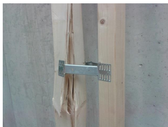
Joonis L5.6. Kartro post 3 purunemispilt 2
