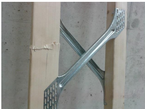
Joonis L5.7. Posi post 1 purunemispilt 1
