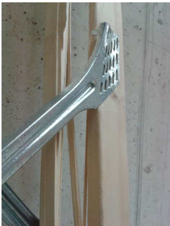
Joonis L5.25. Posi post 4 purunemispilt 1
