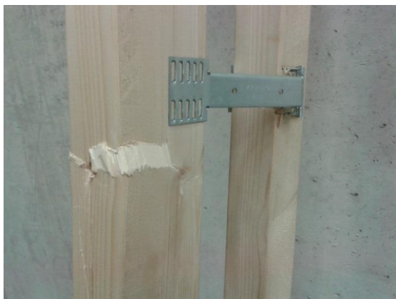
Joonis L5.1. Kartro post 1 purunemispilt 1
