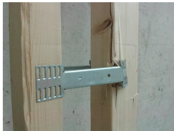
Joonis L5.2. Kartro post 1 purunemispilt 2
