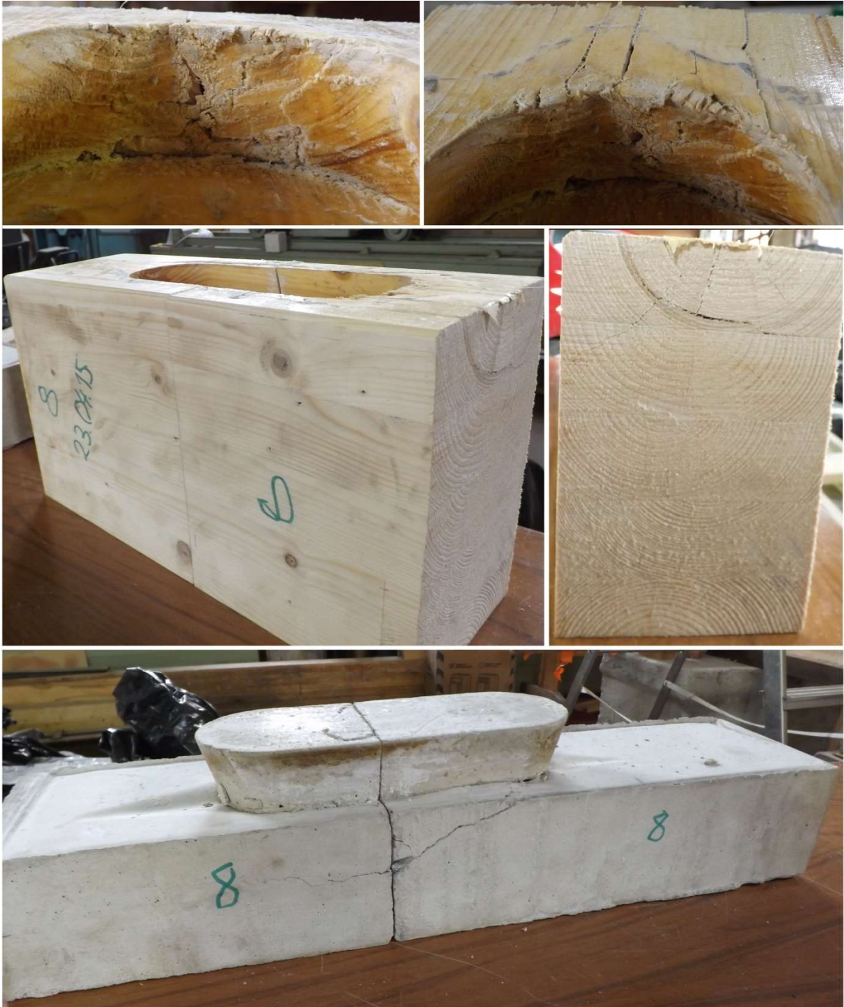
Katsekeha 8 - puidu tugev muljumine ja plokkpurunemise märgid. Betoonis paindepragu, tapp nihkeliites tugevalt kinni
