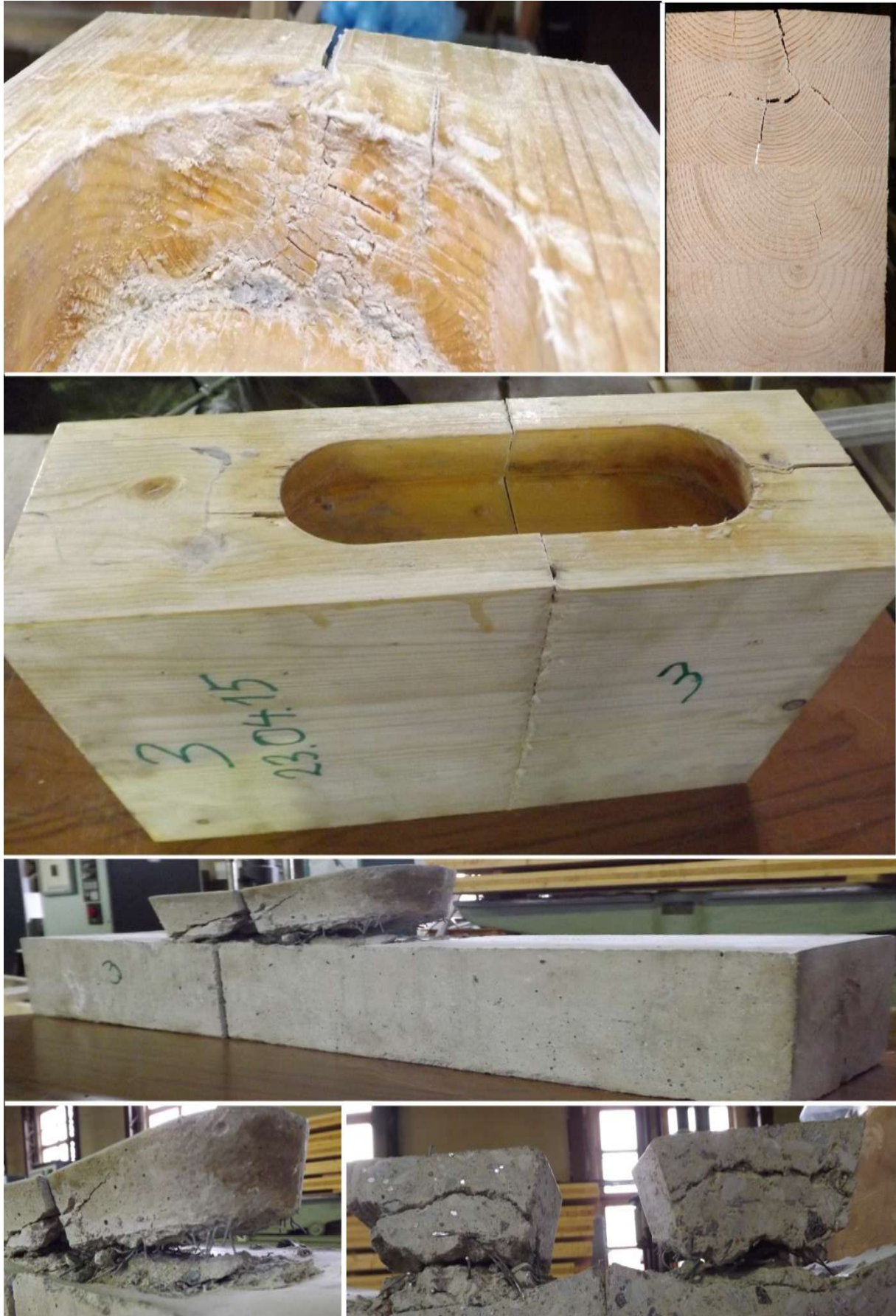
Katsekeha 3- betoontapi rabe purunemine, lisaks tugevalt muljutud puit ja plokkpurunemise märgi
