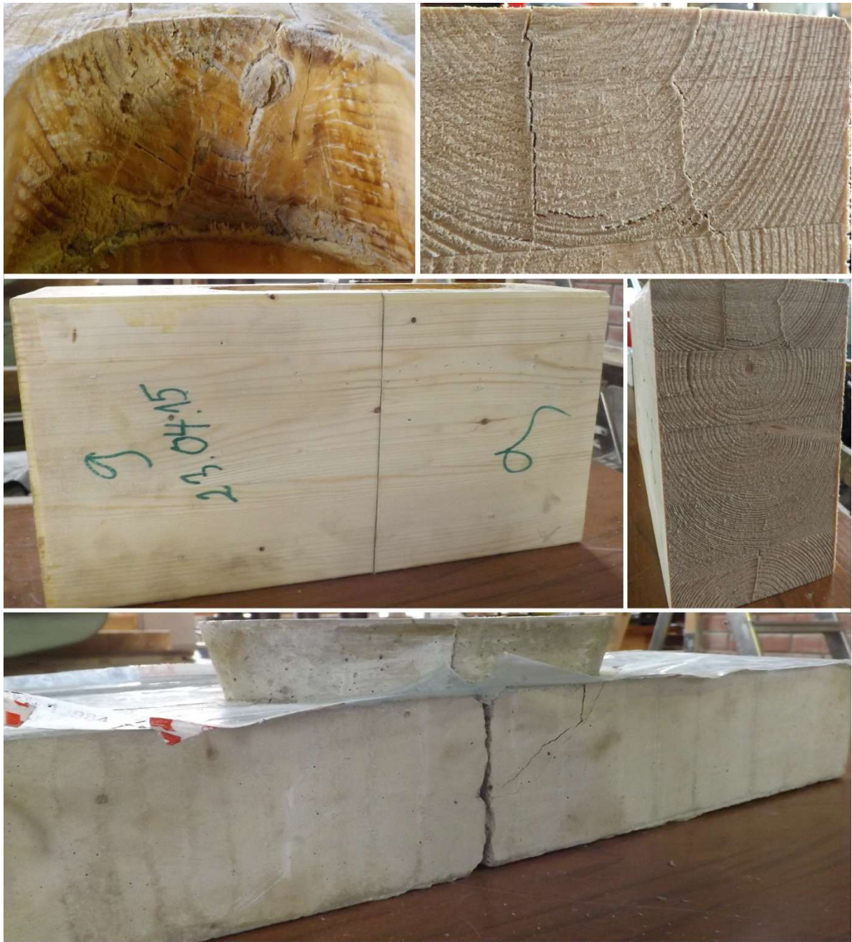
Katsekeha 9 - puidu tugev muljumine, plokkpurunemise märgid. Betoonis paindepragu, nihketasapinnas terve.
