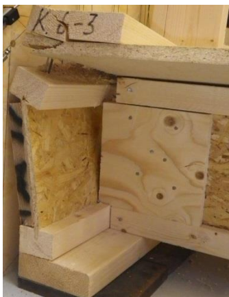
Joonis L3.67. Katsekeha K6-3 vaade küljelt katse lõpus. (foto M. J. Miljan)
