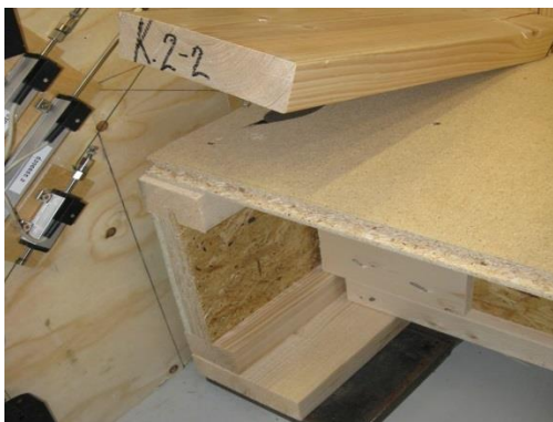
Joonis L3.15. Katsekeha K2-2 vaade küljelt katse lõpus. (foto. M. J. Miljan)
