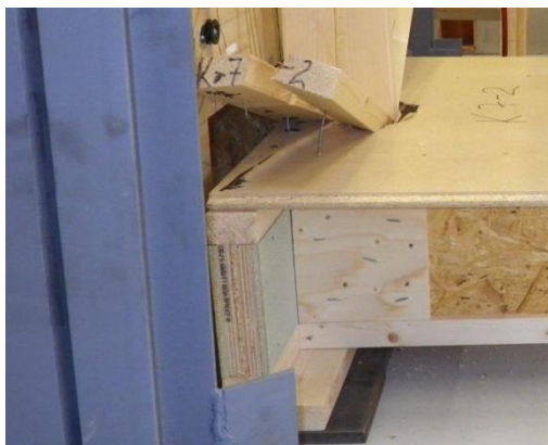
Joonis L3.75. Katsekeha K7-2 vaade küljelt katse lõpus. (foto M. J. Miljan)
