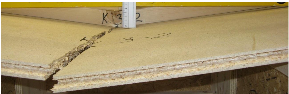
Joonis L3.29. Katsekeha K3-2 vaade tagant/ ülevalt katse lõpus. (foto. M. J. Miljan)
