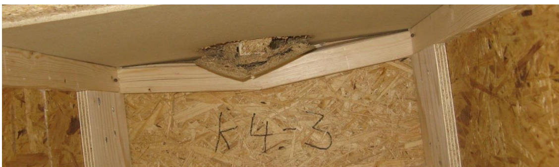
Joonis L3.46. Katsekeha K4-1 vaade tagant/alt katse lõpus. (foto. M. J. Miljan)
