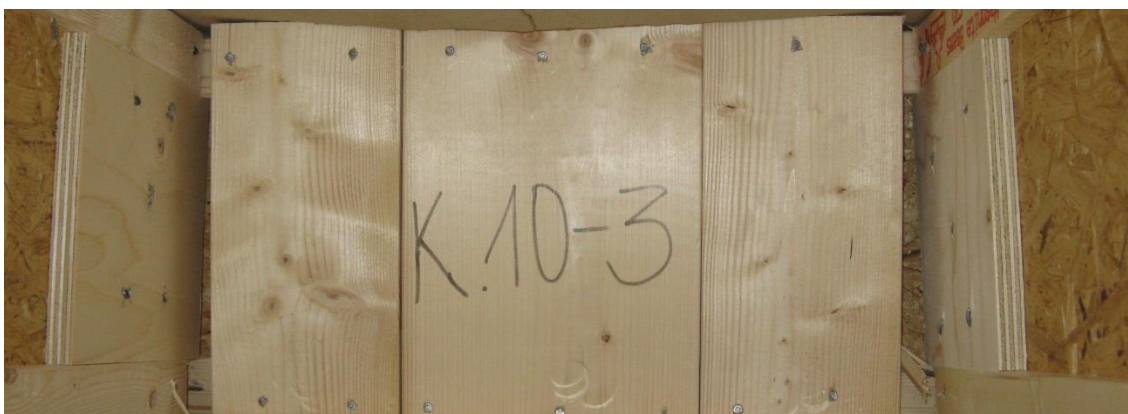
Joonis L3.118. Katsekeha K10-3 vaade tagant/alt katse lõpus. (foto M. J. Miljan)
