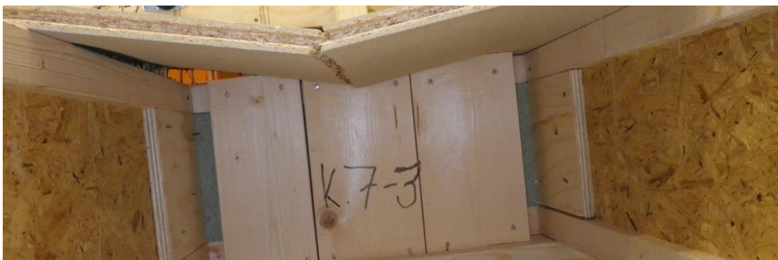
Joonis L3.82. Katsekeha K7-3 vaade tagant/alt katse lõpus. (foto. M. J. Miljan)
