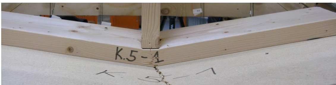
Joonis L3.49. Katsekeha K5-1 vaade tagant/ ülevalt katselõpus.(foto. M.-J. Miljan)
