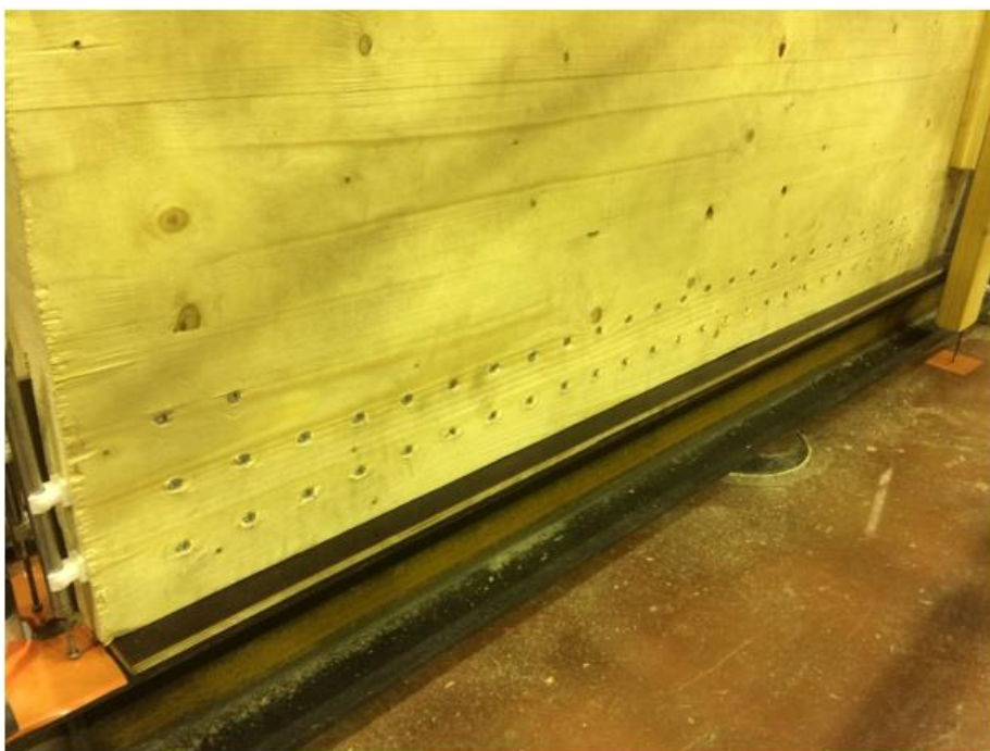
Joonis 6.8. Naaglite paigutus liites
