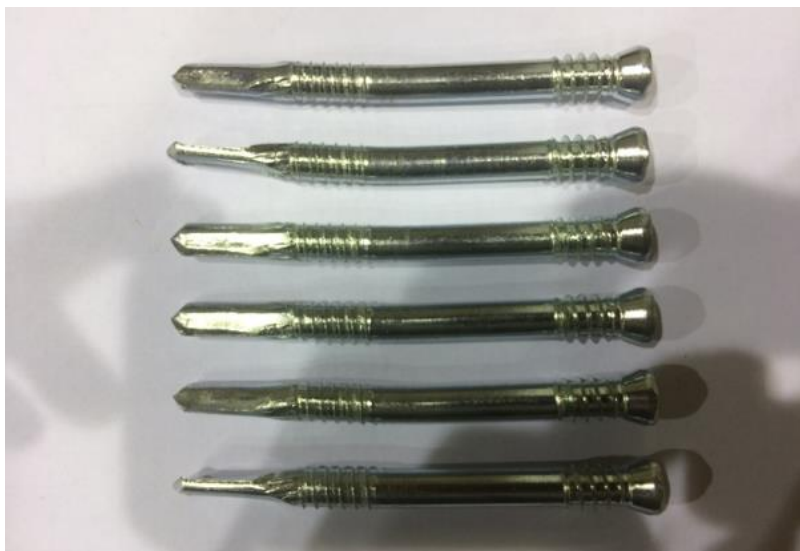
Joonis 6.10. Minimaalsel määral plastselt deformeerunud naaglid
