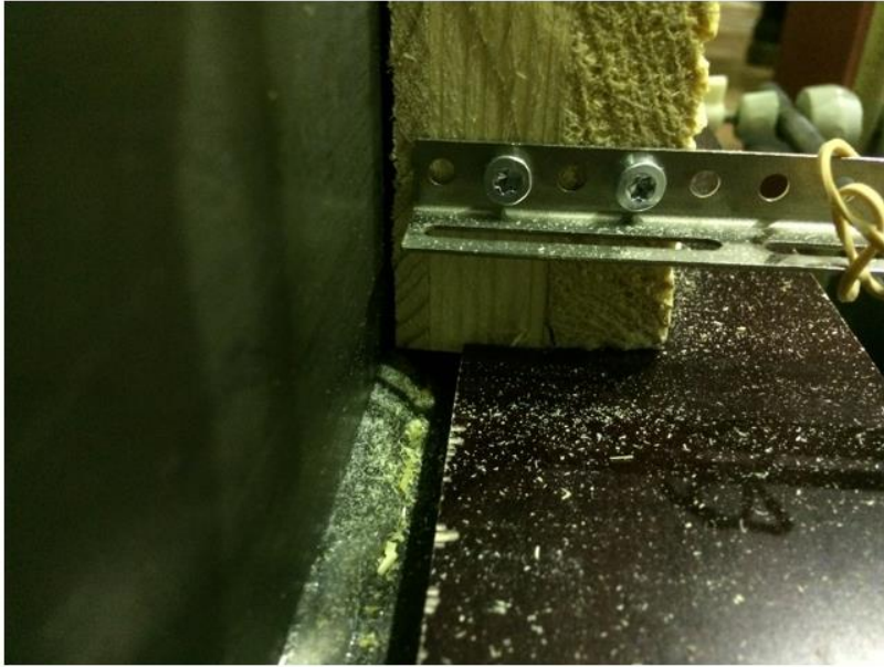
Joonis 6.4. CLT paneeli muljumine survetsoonis
