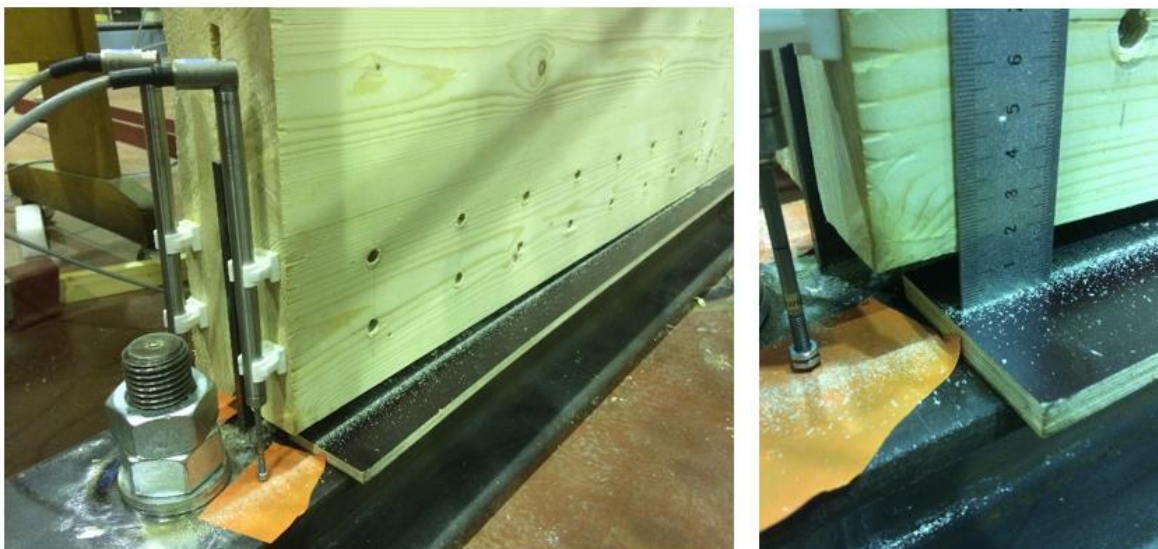
Joonis 6.1. Nurga tõusu jääksiire maksimumkoormuse järgselt
