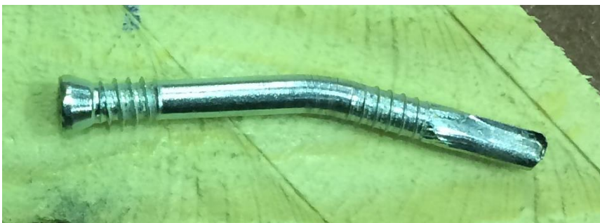
Joonis 6.3. Plastselt deformeerunud naagel
