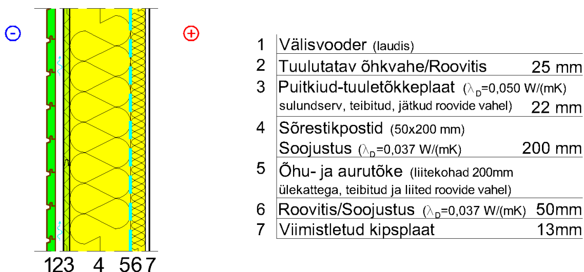
Joonis 31. Niiskustehnilisteks arvutusteks valitud baastarind; U = 0,17 \text{ W}/(\text{m}^2 \cdot \text{K}) ; M = 0,99 .
