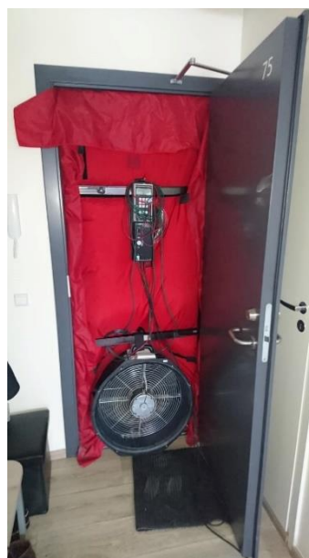
Joonis 11. BlowerDoor seade korteri ukseavas (autori foto).
