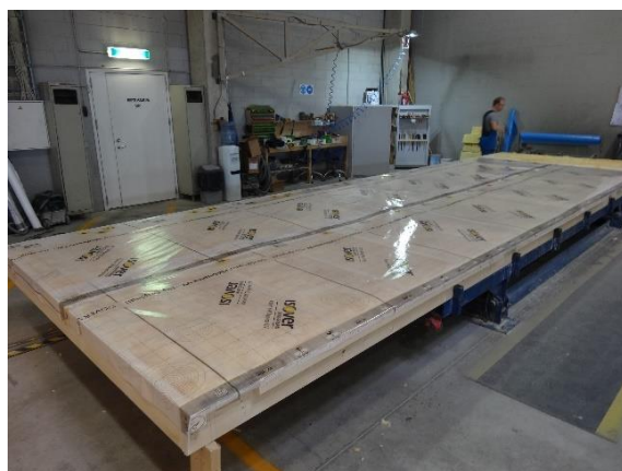
Joonis 20. Aurutõkketile paigaldamine (vasakul) ja elemendi täitmine kahe kihi villaga (paremal).
