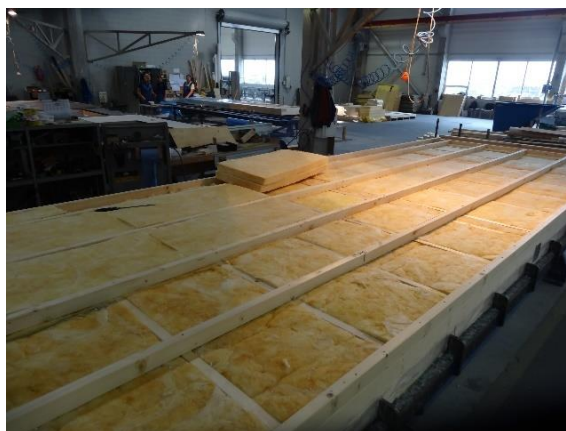
Joonis 20. Aurutõkketile paigaldamine (vasakul) ja elemendi täitmine kahe kihi villaga (paremal).
