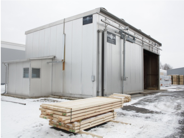
Joonis 12. Katsekehad hetk enne kamberkuivatisse asetamist
