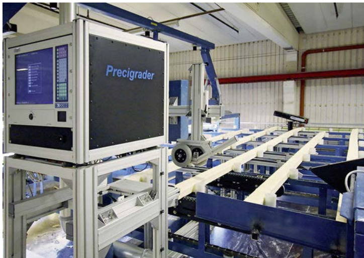
Joonis 8. Dynalyse AB Precigrader tugevussorteerimiseade [26]
