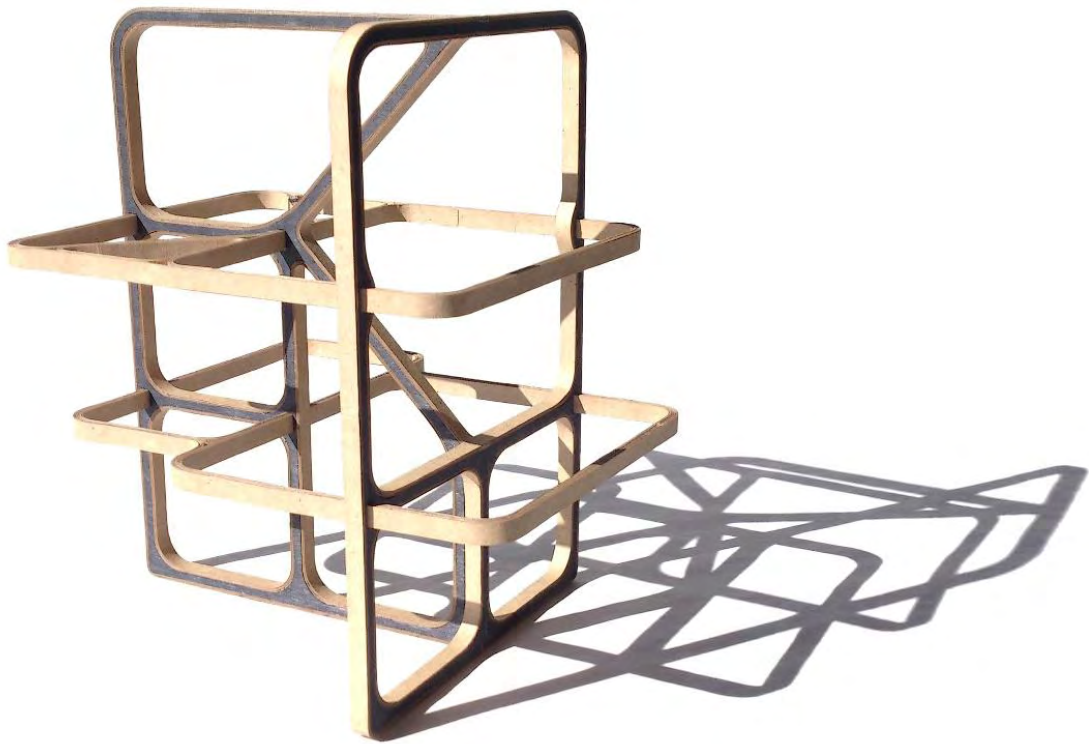
joonis 19. Makett kolmes tasandis ristuvatest fermidest. allikas: autori foto
