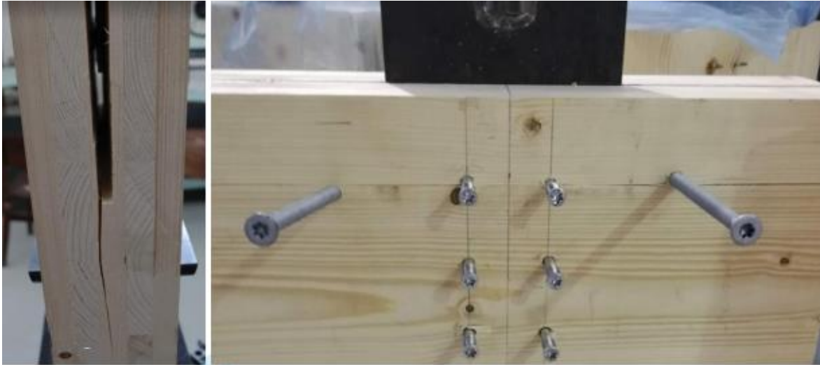
Joonis 3.16. SBD 7,5x195 naaglitega katsekehade tugevdamine
