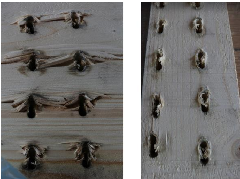
Joonis 3.15. Mitme naagliga liite iseloomulik pilt pärast katsetamist, vasakul 90° ja paremal 0° välimiste lamellide suunaga katsekeha
