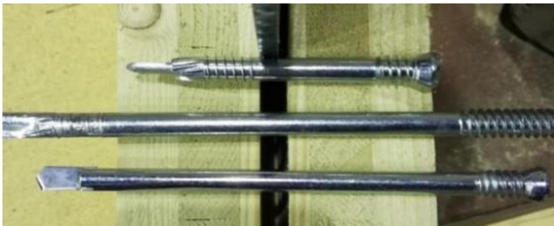
Joonis 2.4. SBD 7,5x95 (ülemine), SBD 7,5x195 (keskmine) ja WS-7x153 (alumine) naagli asetus katsekehas
