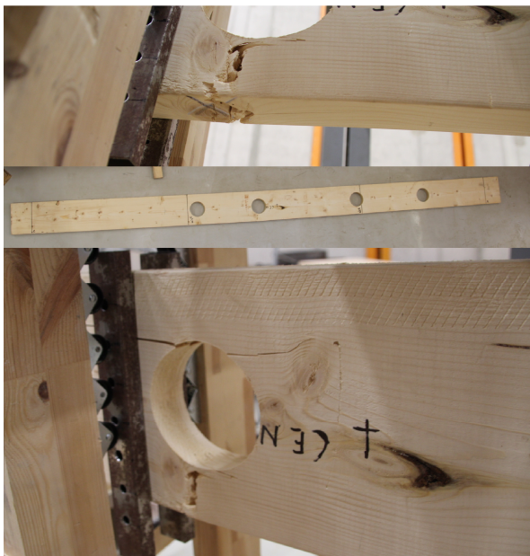
Joonis 3.9 Tala 6 purunemise koht ja asukoht.
