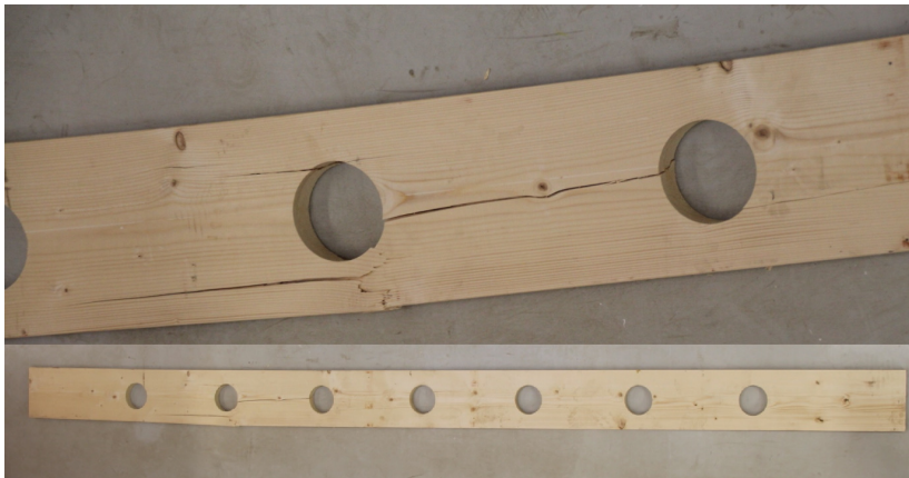
Joonis 3.5 Tala 13 purunemine ja asukoht talal.
