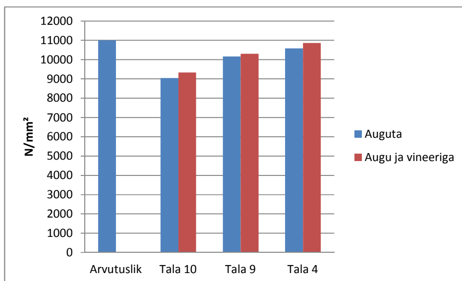
Joonis 4.10 Paindeelastsusmoodul EVS-EN 408:2010+A1 2012 järgi. Arvutuslik paindeelastsusmoodul, talade 12, 3, 2 katselised elastsusmoodulid enne aukude tegemist ning pärast augustamist ja vineerplaatide kinnitamist.
