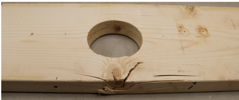
Joonis 3.14 Tala 2 purunemise koht.
