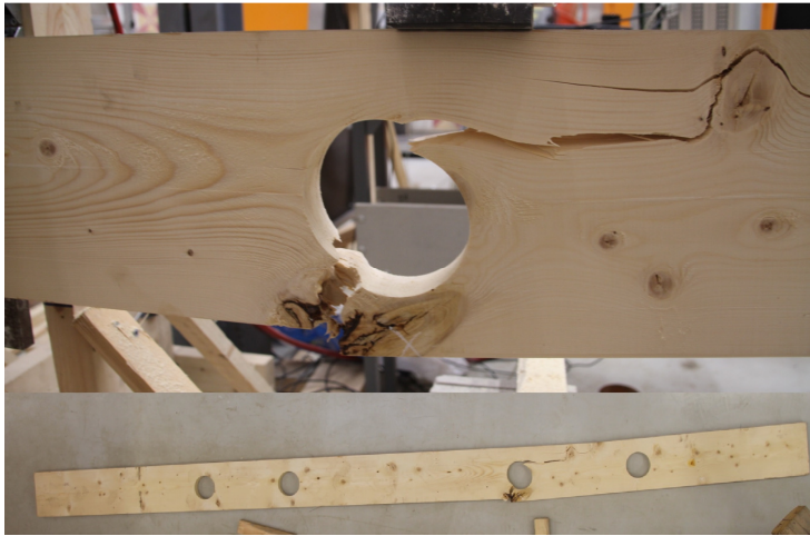
Joonis 3.8 Tala 1 purunemise koht ja asukoht talal.
