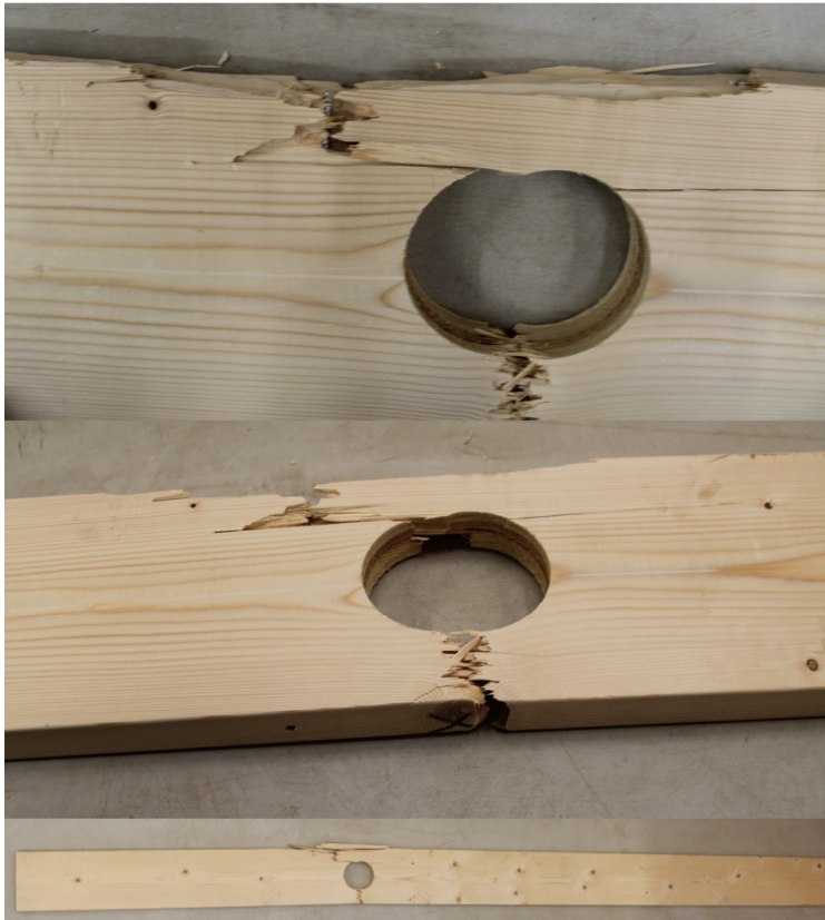
Joonis 3.13 Tala 3 purunemise koht.
