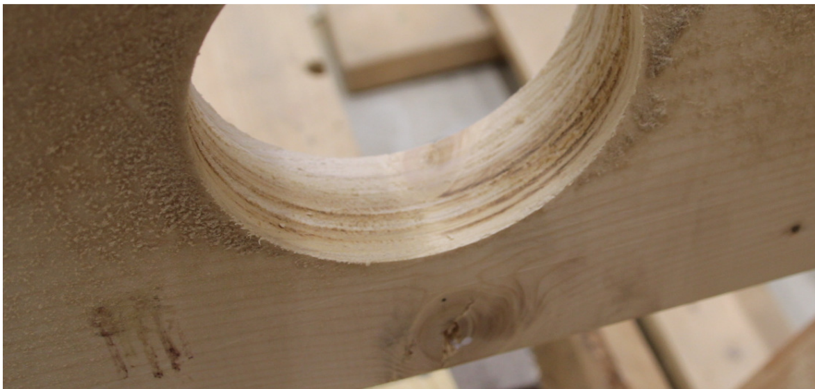
Joonis 2.8 121mm auk tehtud võimalikult lähedale oksakohale.
