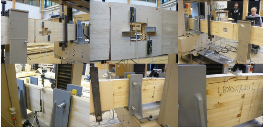
Joonis 1.13 Talade tugevdamine liimitud vineeriga, mis kinnitatud naeltega [15].
