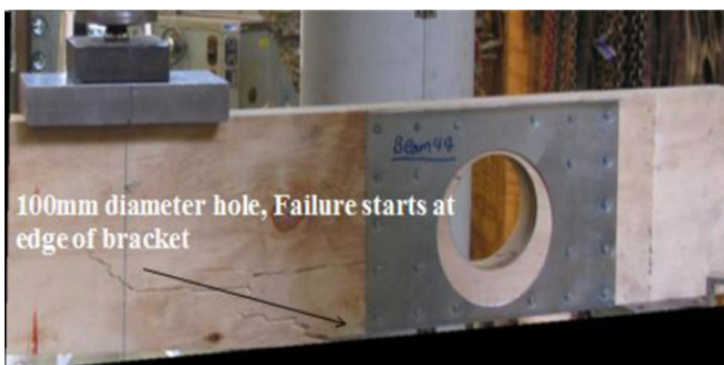
Joonis 1.17 Tala tugevdus terasest ümbrisega, mis on kinnitatud naeltega [16].
